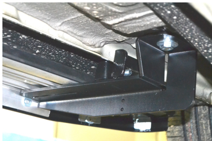
Рис. 4 - Установка задних кронштейнов
