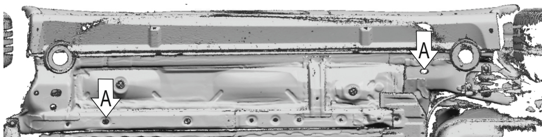
Рис. 1 - Установка закладных гаек
