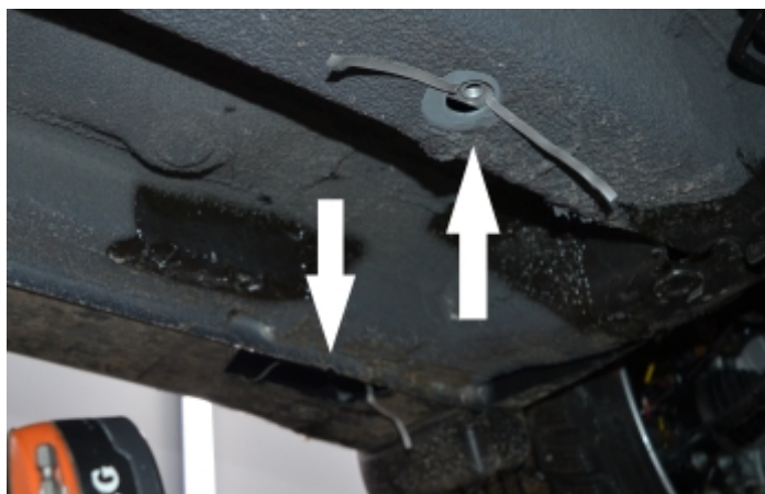
Рис. 1 - Установка фиксируемых гаек в передней части автомобиля
