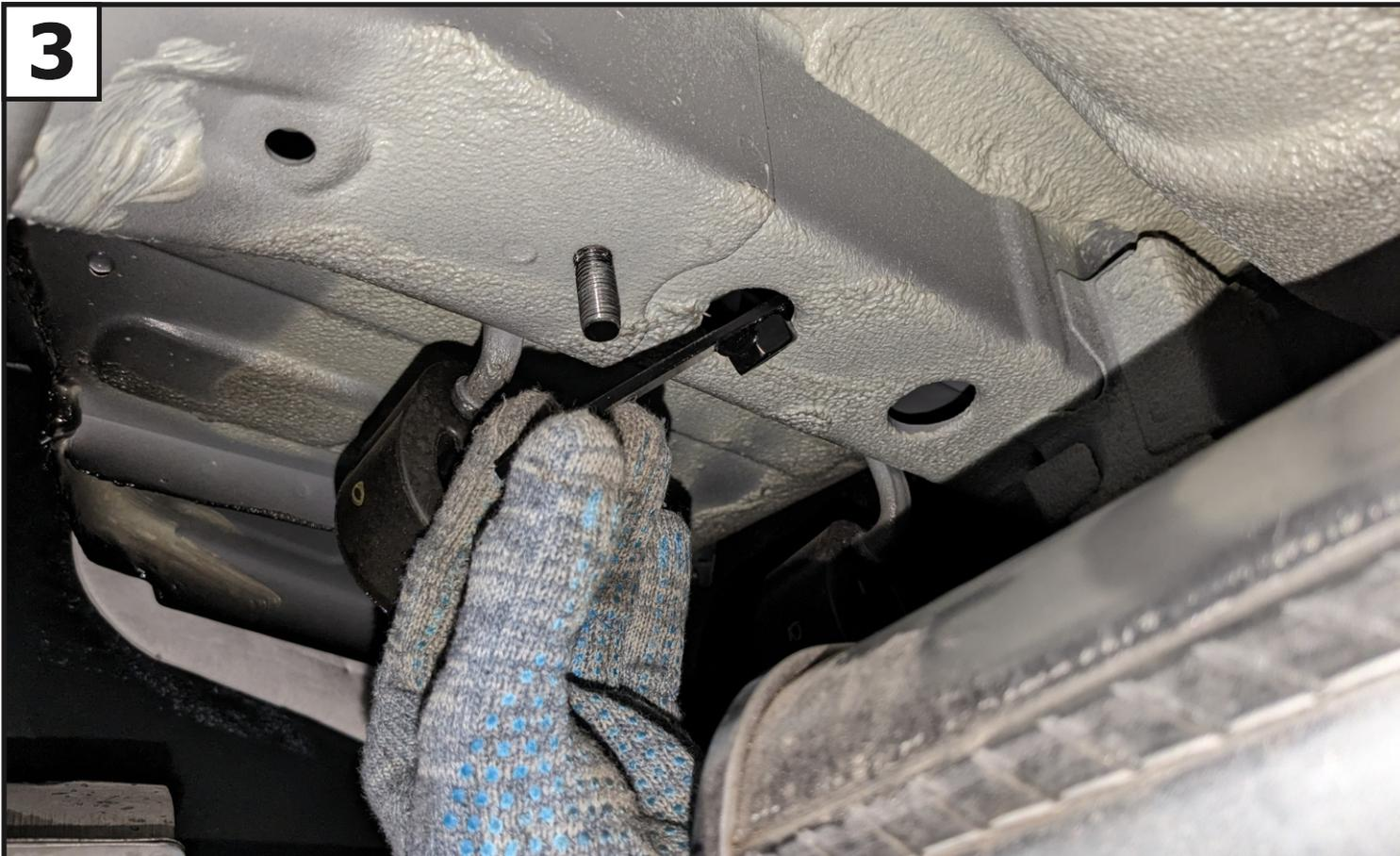
Установить закладную (9) в отверстие левого лонжерона и выставить ее соосно резьбовыми частями с отверстиями лонжерона. С правой стороны аналогично.
