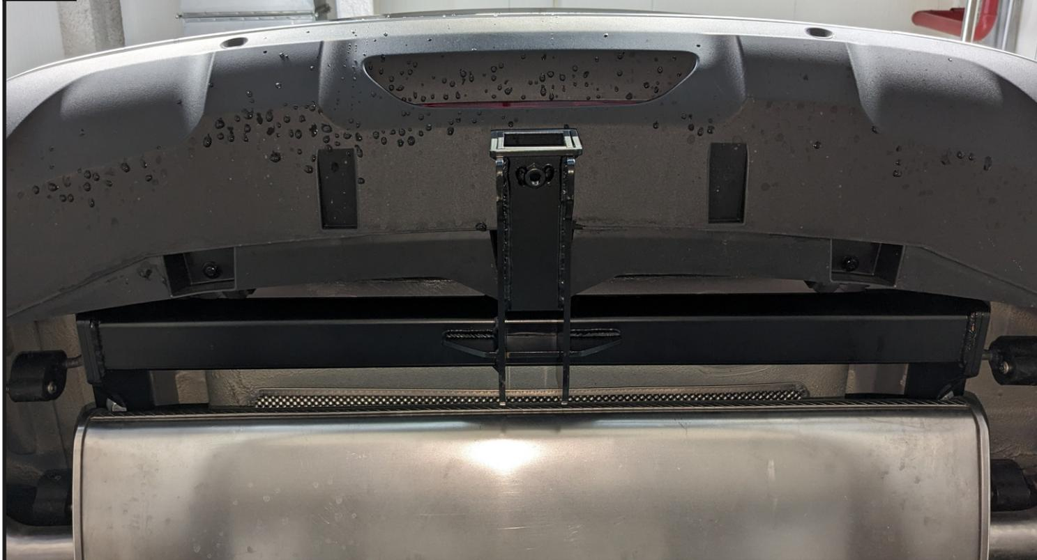
Отрегулировать положение ТСУ относительно центра автомобиля и затянуть все резьбовые соединения — сначала балку с кронштейнами, затем кронштейны с лонжеронами автомобиля. Моменты затяжки: М10=47 Нм, М12=81 Нм.
