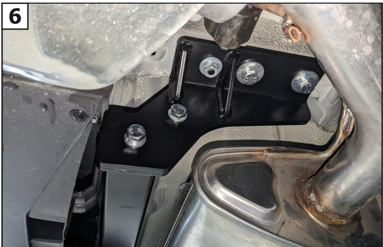
К установленным кронштейнам (2 и 3) закрепить балку (1) с помощью болтов M12x1,25x40 (14), шайб 12 пружинных (25), шайб 12 (24) и гаек M12x1,25 (18).
