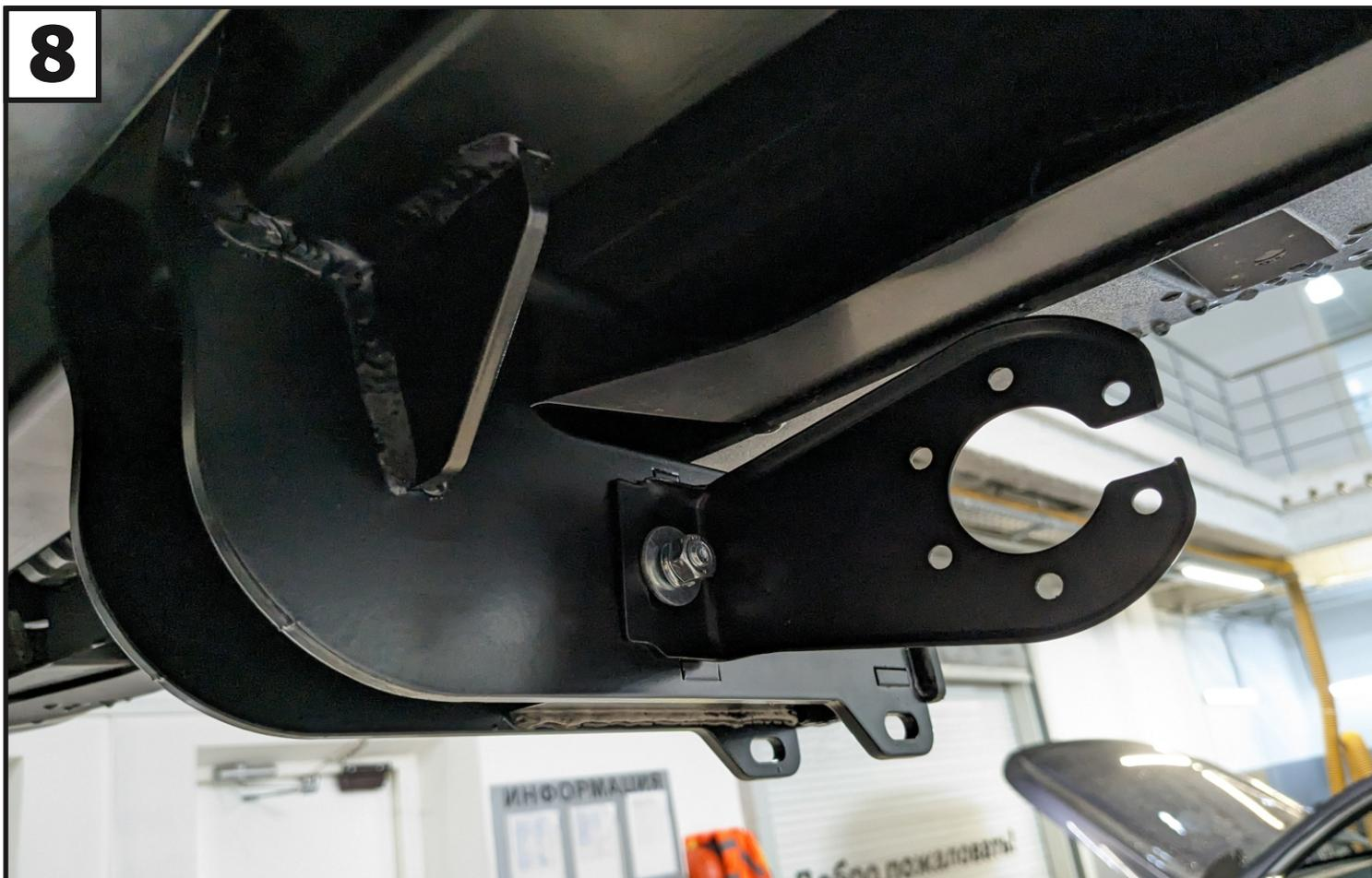
Установить кронштейн под розетку (8) на балку (1) с помощью болта М8х80 (12), шайбы 8 (19), шайбы 8 пружинной (20), шайбы 8 увел. (21) и гайки М8 (16).
