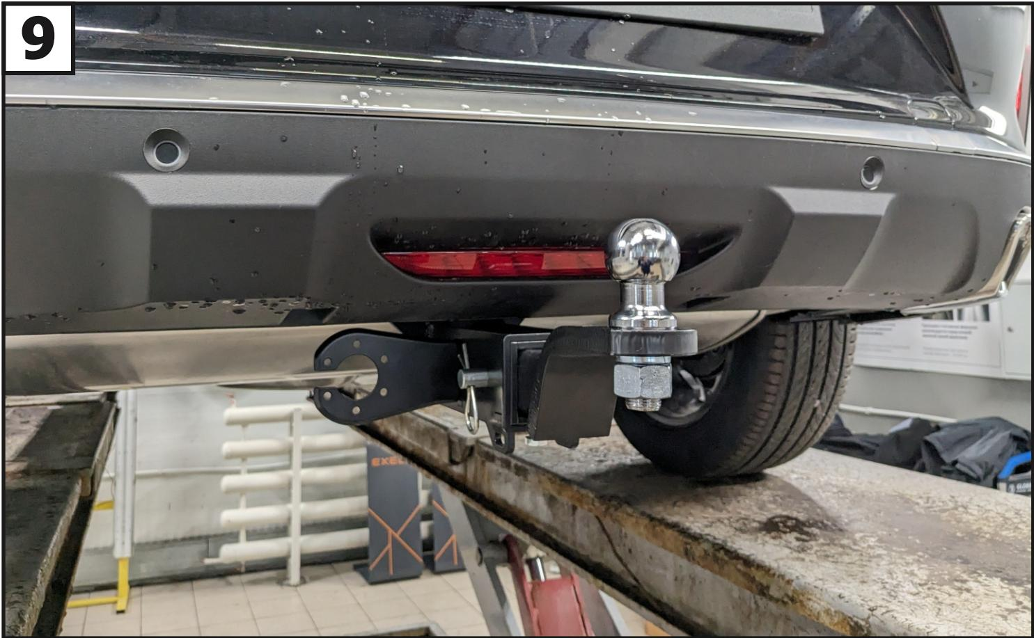
Установить переходник (4), закрепив с помощью штифта (6) и шплинта (7). Зафиксировать переходник болтом M10x20 (13) - фиксацию использовать только без нагрузки. Установить на переходник шар (5), закрепив гайкой M24 (27) с шайбой 24 пружинной (28).
