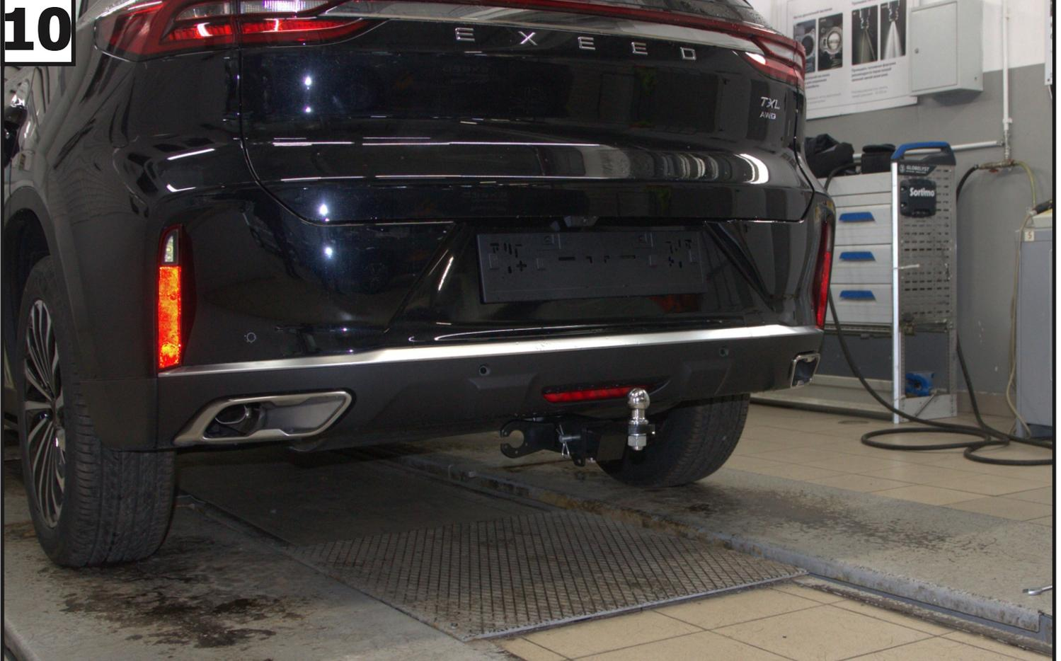
Затянуть все резьбовые соединения. Моменты затяжки: М8=25 Нм, М24=95 Нм.
