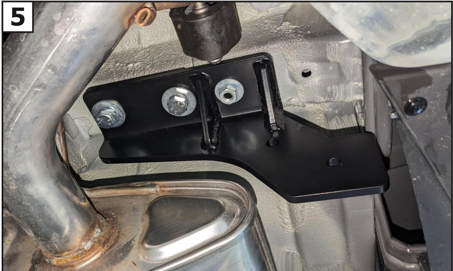
Установить левый кронштейн (2) совместно с проставками кронштейна (9), закрепив его к установленным закладным (10 и 11) с помощью болтов M12x1,25x45 (15), шайб 12 пруж. (25) и шайб 12 увел. (26), гаек M10x1,25 (17), шайб 10 пруж. (22) и шайб 10 увел. (23). Правый кронштейн (3) устанавливается аналогично.
