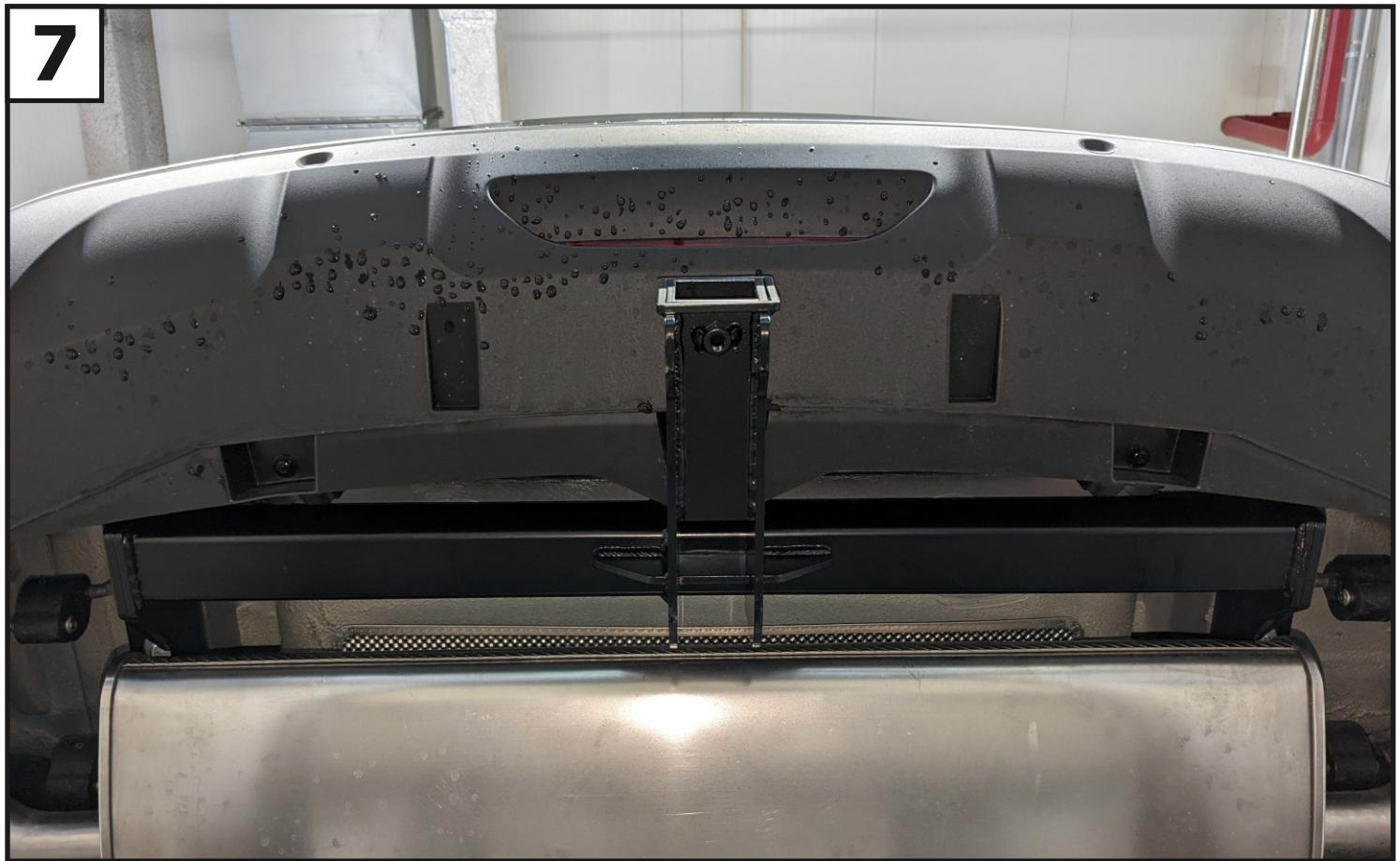
Отрегулировать положение ТСУ относительно центра автомобиля и затянуть все резьбовые соединения — сначала балку с кронштейнами, затем кронштейны с лонжеронами автомобиля. Моменты затяжки: M10=47 Нм, M12=81 Нм.
