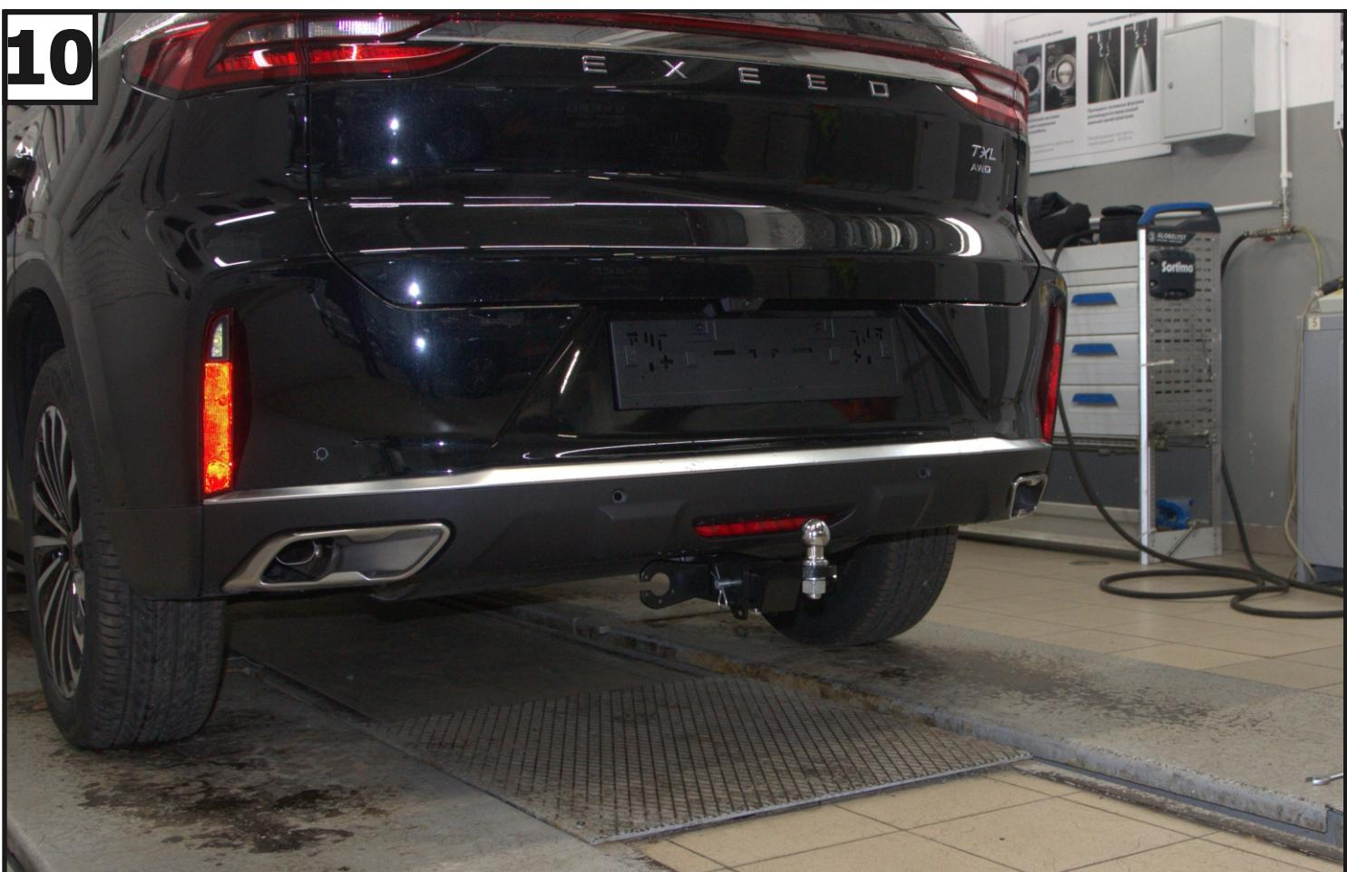
Затянуть все резьбовые соединения. Моменты затяжки: M8=25 Нм, M24=95 Нм.
