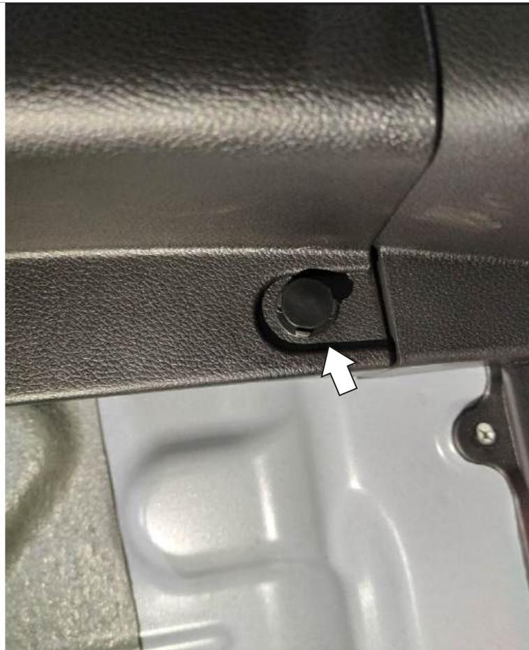
**Демонтировать клипсы крепления обшивки багажника.**
