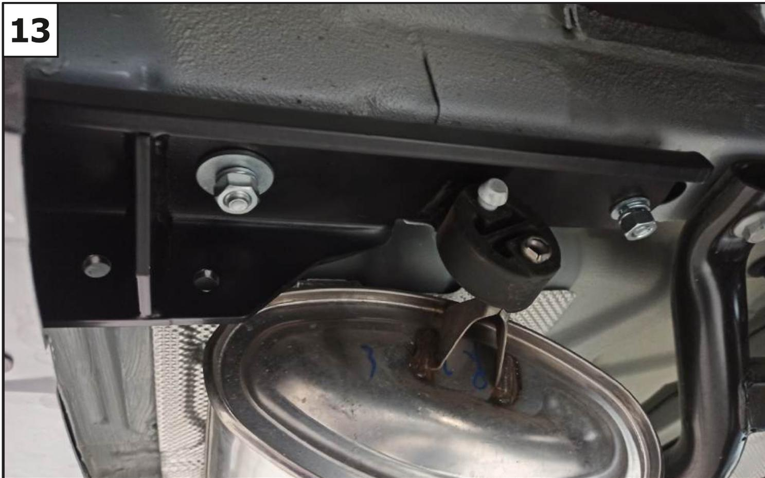
Закрепить правый и левый кронштейн (3 и 2) с помощью гаек М12 (14), шайб 12 (16) и шайб 12 пружинных (18).
