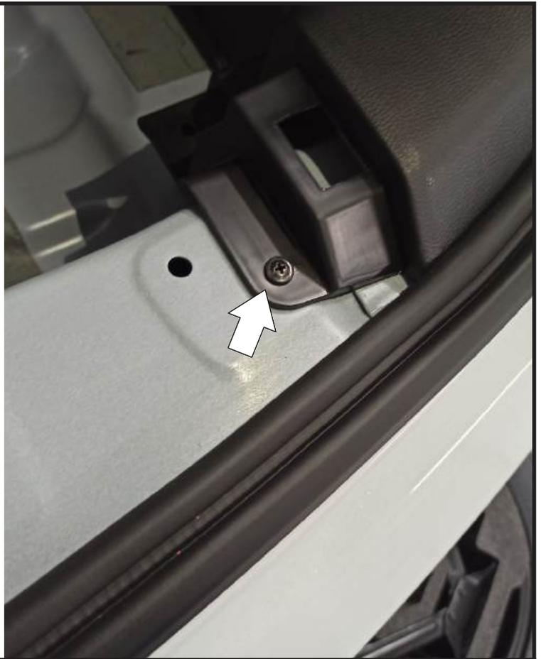
Выкрутить винты крепления обшивки багажника и отогнуть обшивку с двух сторон.
