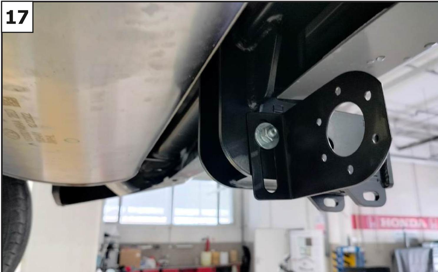
Установить кронштейн под розетку (8) с помощью болта М8х80 (11), шайбы 8 (19), шайбы 8 увел. (20), шайбы 8 пружинной (21) и гайки М8 (15). Момент затяжки М8=25 Нм.
