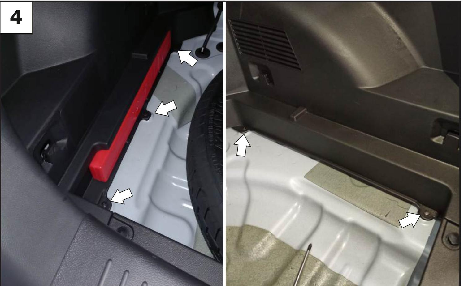
Выкрутить винты крепления обшивки багажника.
