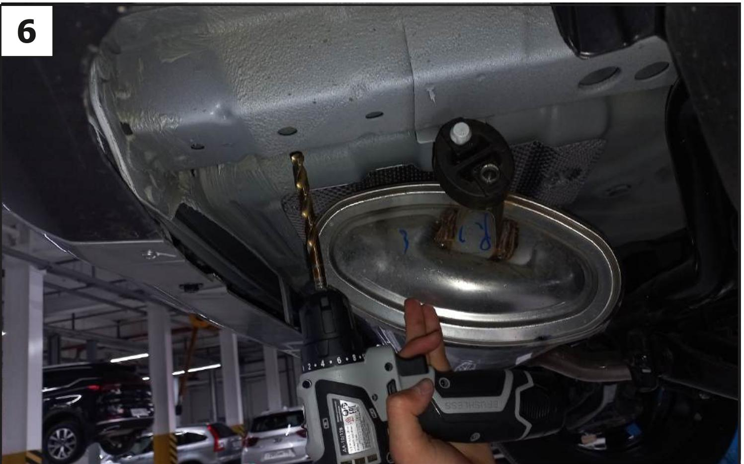
Через отверстие в лонжероне просверлить пол багажника сверлом диаметром 12,5 мм. Со стороны багажника рассверлить это отверстие до диаметра 20 мм. С другой стороны аналогично.
