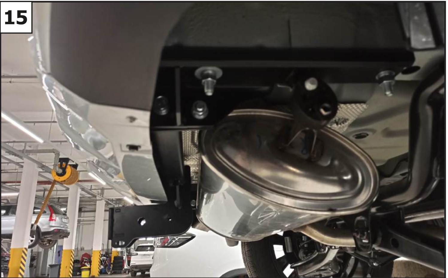
К установленным кронштейнам закрепить балку (1) с помощью болтов М12х1,25х35 (9), шайб 12 (16), шайб 12 пружинных (17) и гаек М12х1,25 (13).
