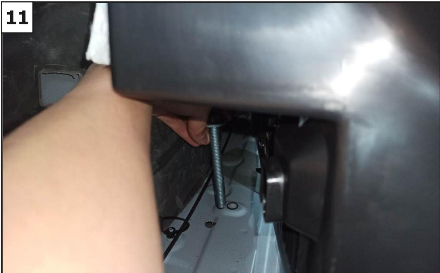
Установить болты М12х100 (10) и шайбы 12 увел. (18) в дальние отверстия с двух сторон.
