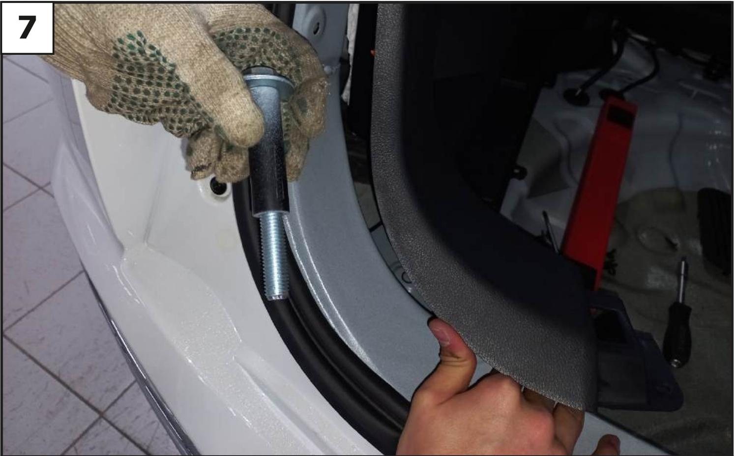
Установить в рассверленные отверстия болты М12х100 (10) с шайбами 12 увел. (18) и втулками (24).
