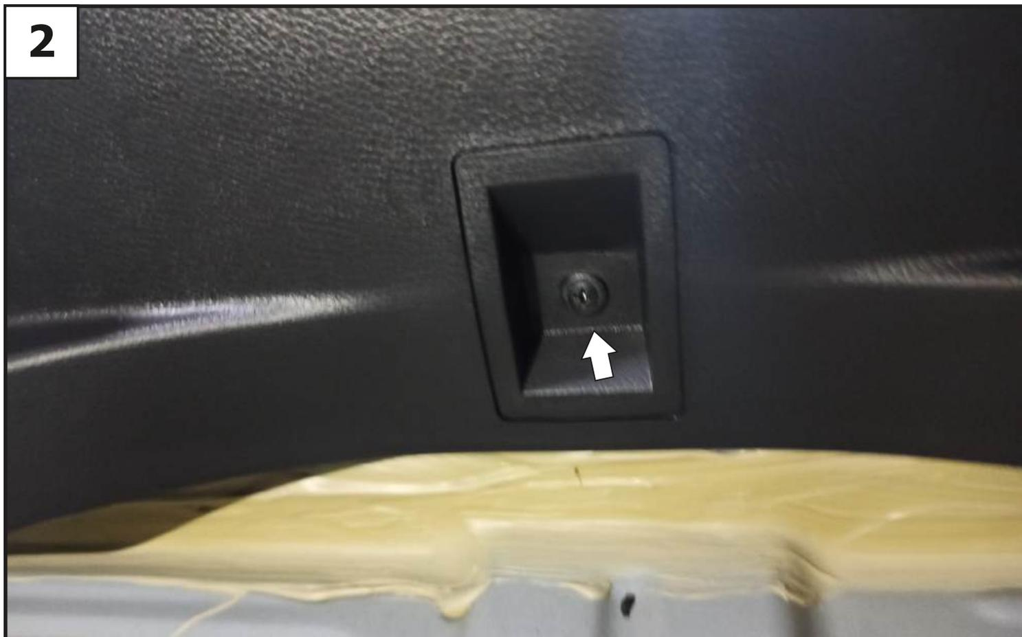
**В центре накладки выкрутить винт крепления обшивки багажника.**
