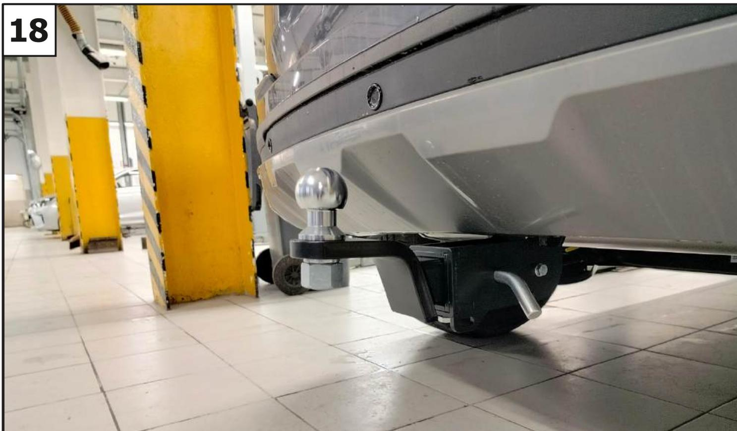
Установить переходник (4), закрепив с помощью штифта (6) и шплинта (7). Зафиксировать переходник болтом М10х20 (12) - фиксацию использовать без нагрузки. Установить на переходник шар (5), закрепив гайкой М24 (23) с шайбой 24 пружинной (24). Момент затяжки: М24=95 Нм
