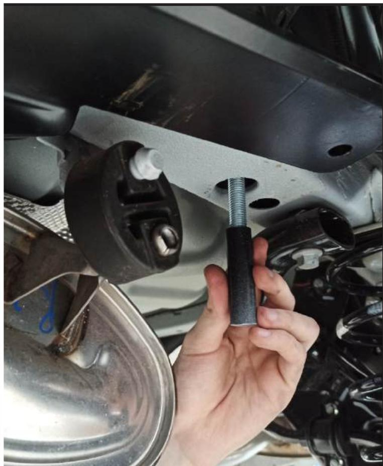
Отодвинуть не закрепленную часть кронштейна и установить снизу втулки (24) в дальние отверстия.
