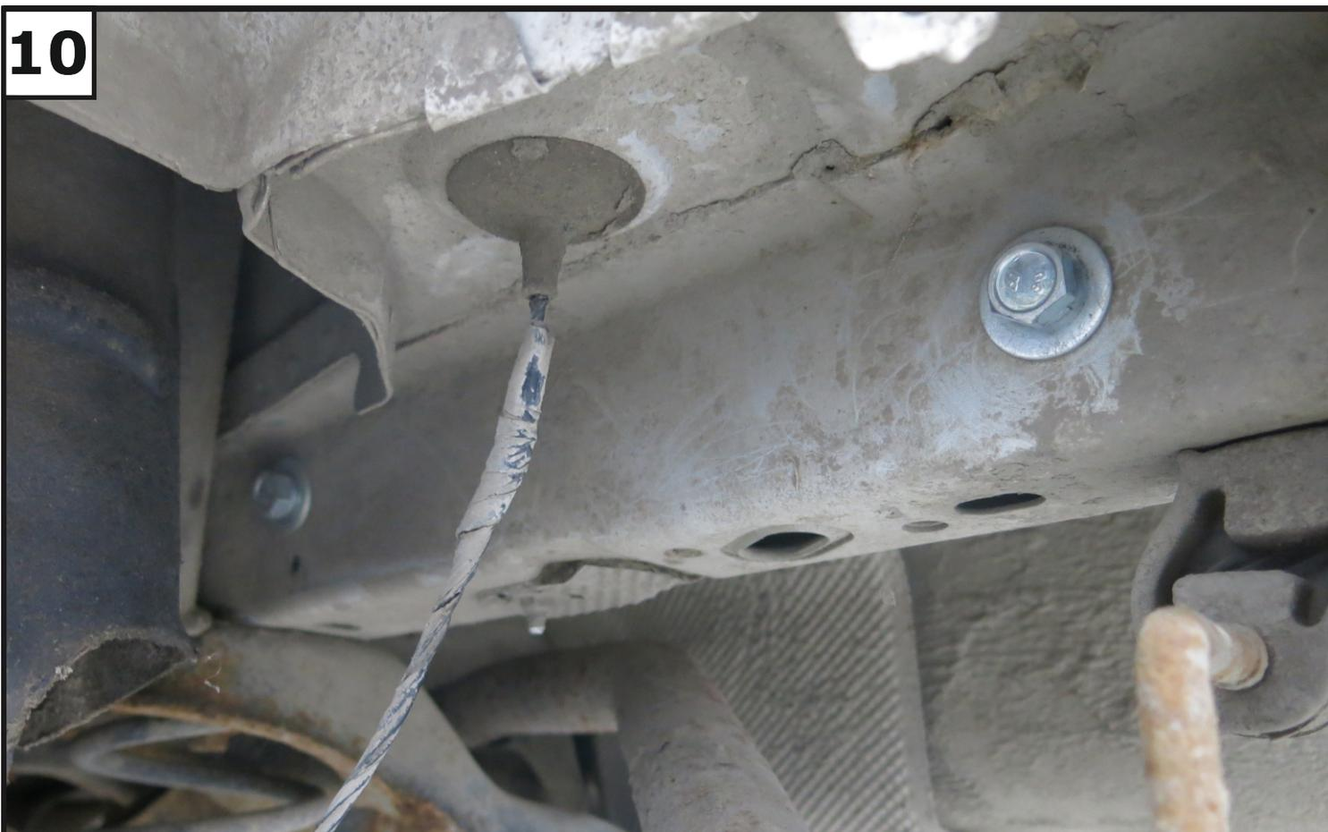
**Закрепить усиление кронштейна левое (2) в лонжероне автомобиля с помощью болтов М10х1.25х30 (8), шайб 10 пружинных (12) и шайб 10 увел. (14).**
