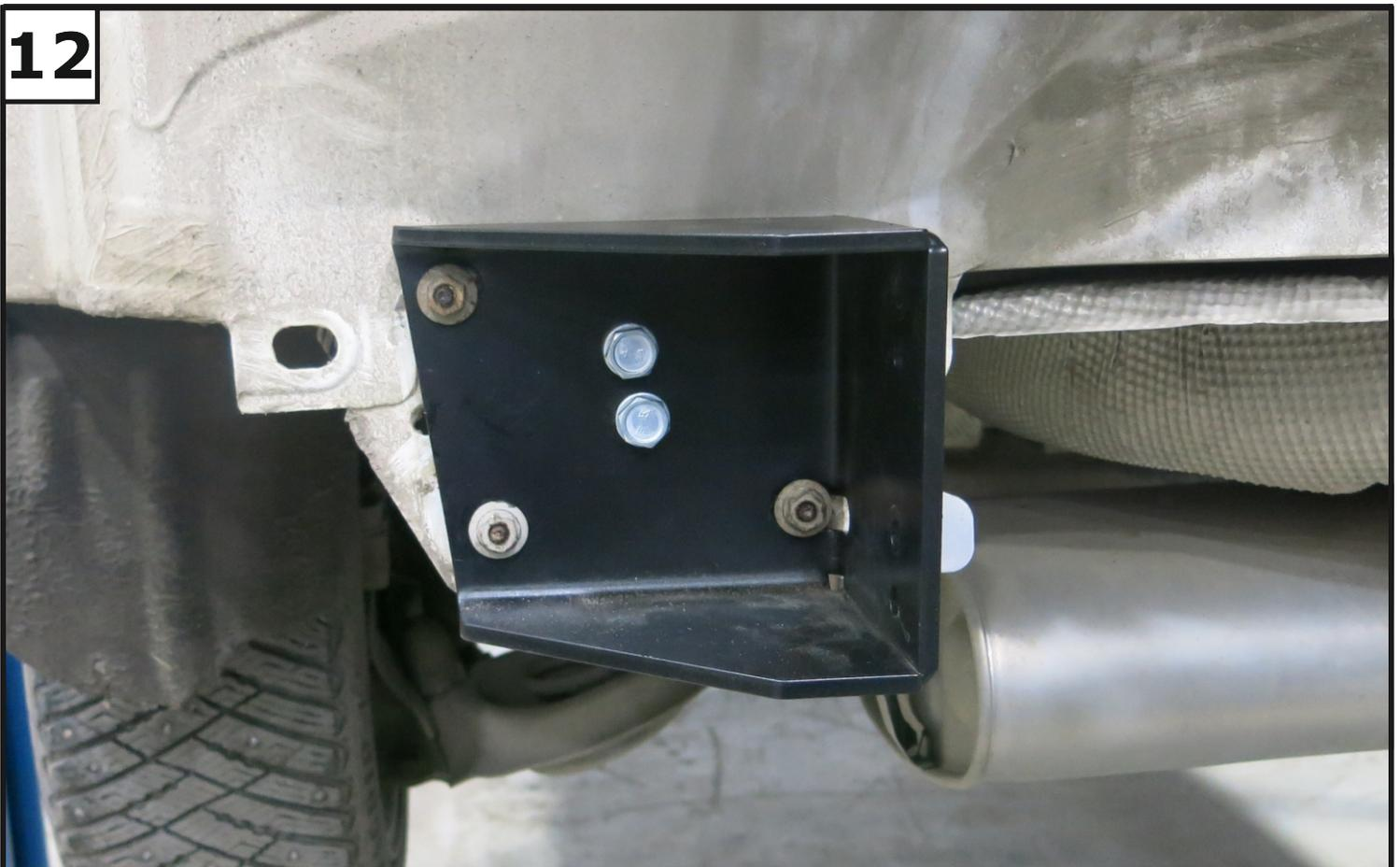
Установить кронштейн левый (4), закрепив к усилению кронштейна с помощью болтов М10х1.25х30 (8), шайб 10 пружинных (12) и шайб 10 (13). Затем прикрутить заводские гайки.
