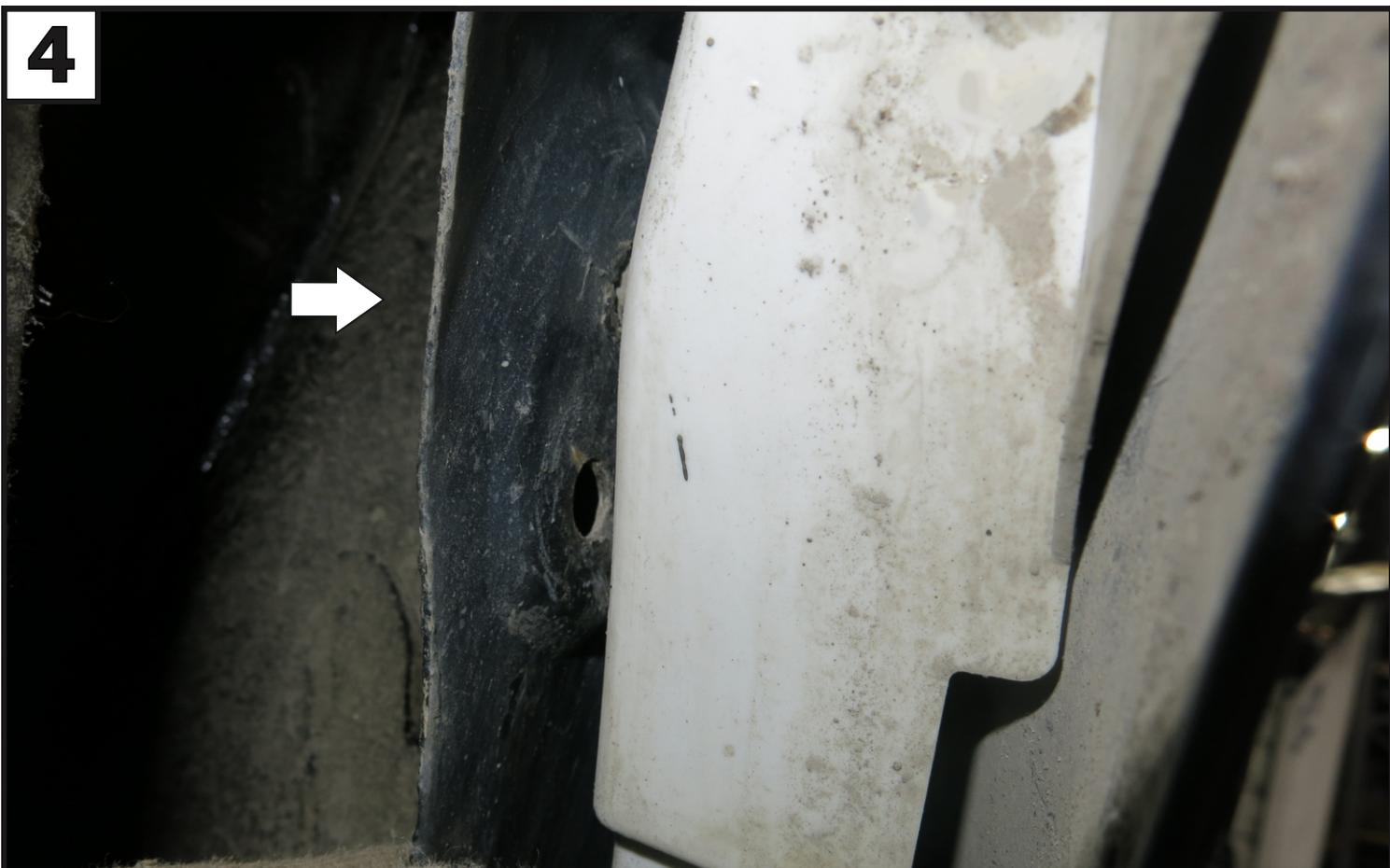
**Для FORD FOCUS 2 за подкрылком открутить гайку М6 крепления бампера. Для другой стороны аналогично. После демонтировать бампера с автомобиля.**
