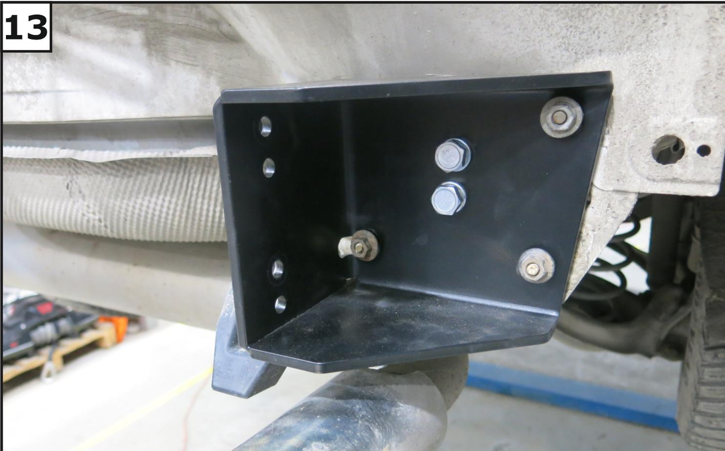
Установить кронштейн правый (5), закрепив к усилению кронштейна с помощью болтов М10х1.25х30 (8), шайб 10 пружинных (12) и шайб 10 (13). Затем прикрутить заводские гайки.
