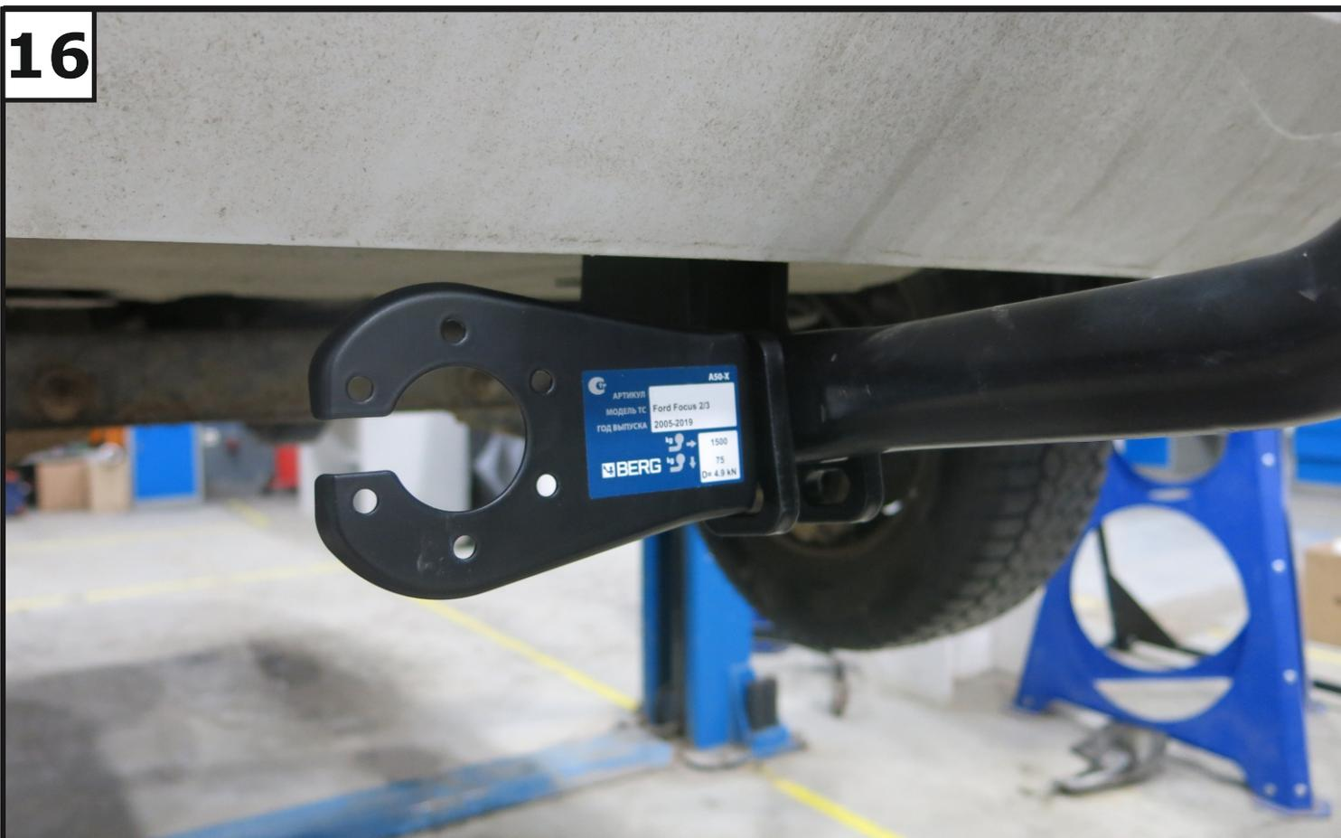
Установить подрозетник (6) и крюк (7) с помощью болтов M12x1.25x70 (9), шайб 12 пружинных (15), шайб 12 (16) и гаек M12x1.25 (11).
