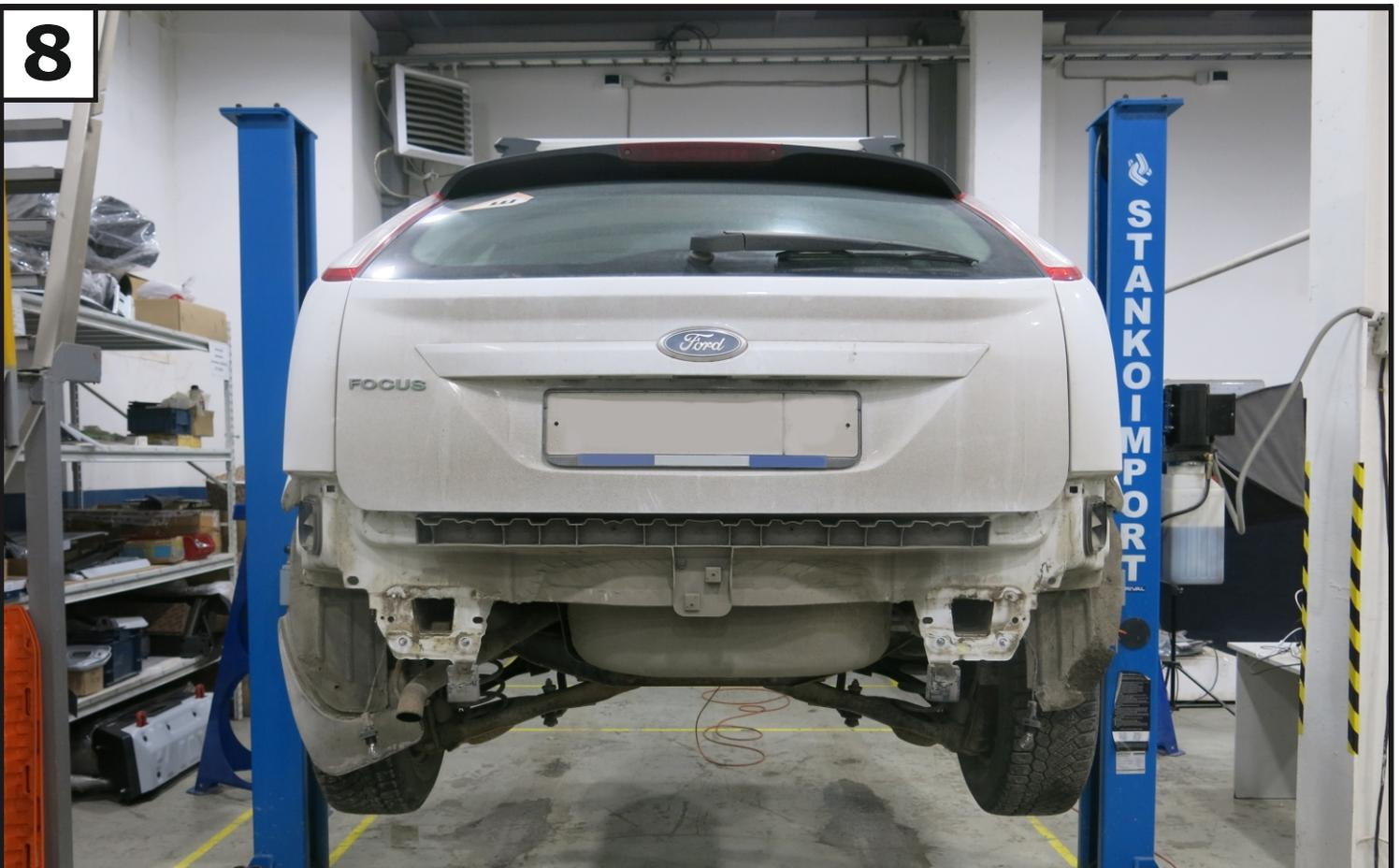
Демонтировать усилитель заднего бампера с автомобиля. Для дальнейшей установки ТСУ усилитель не требуется.
