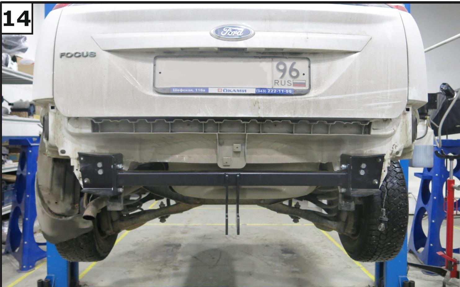
К установленным кронштейнам закрепить балку (1) в нижнее положение с помощью болтов М10х1,25х30 (8), шайб 10 пружинных (12), шайб 10 (13) и гаек М10х1.25 (10).
