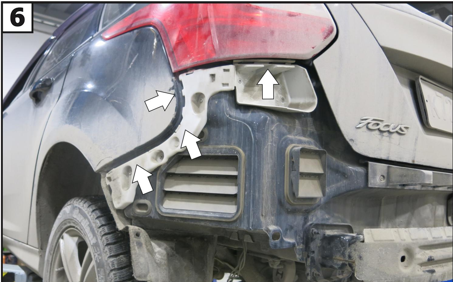
Для FORD FOCUS 3 отщелкнуть защелки крепления бампера с левой и правой стороны. После демонтировать бампер с автомобиля.
