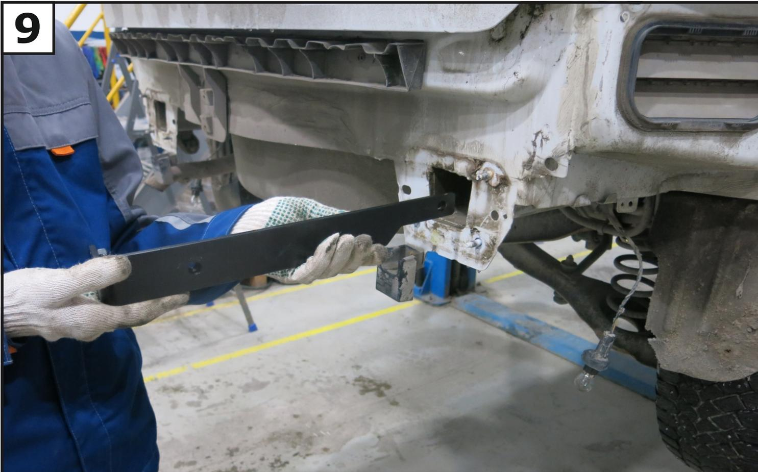
**Установить усиление кронштейна в лонжерон автомобиля. Для другой стороны аналогично.**
