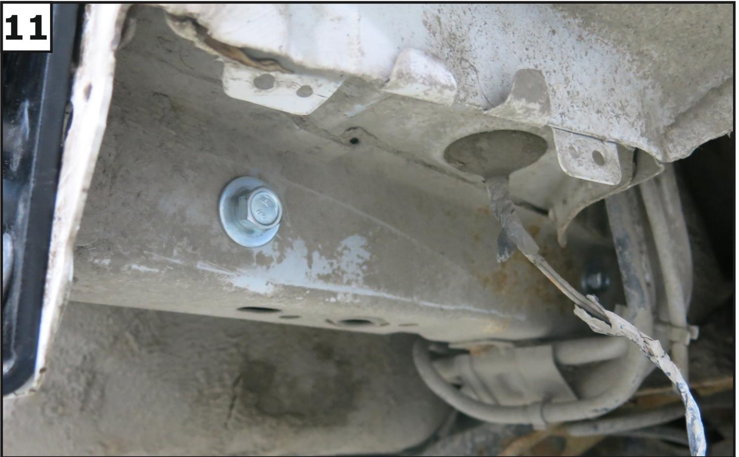
Закрепить усиление кронштейна правое (3) в лонжероне автомобиля с помощью болтов М10х1.25х30 (8), шайб 10 пружинных(12) и шайб 10 увел. (14).
