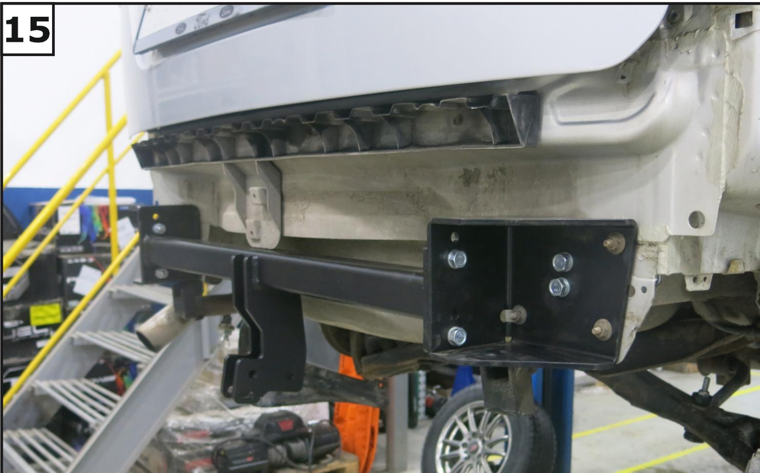
Затянуть все резьбовые соединения. Моменты затяжки: M8=25 Нм, M10=47 Нм.
