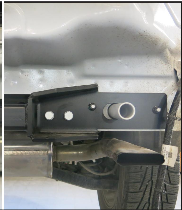
**Установить балку (1) закрепив ее к задней панели автомобиля с помощью штатных гаек крепления усиления бампера. Затем закрепить балку к установленным кронштейнам с помощью болтов M10x1,25x35 (15), шайб 10 (24) и шайб 10 пружинных (26).**
