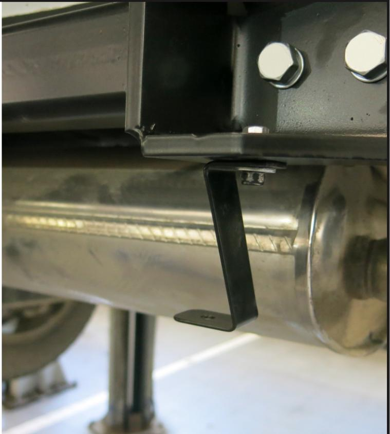
Установить левый (9) и правый (10) кронштейны бампера с помощью болтов M6x25 (13), шайб 6 (19), шайб 6 пружинных (21) и гаек M6 (17). Установить кронштейн антенны (11) по середине балки с помощью болта M6x90 (12), шайб 6 (19), шайбы 6 пружинная (21) и гайки M6 (17). После установить задний бампер в обратной последовательности.
