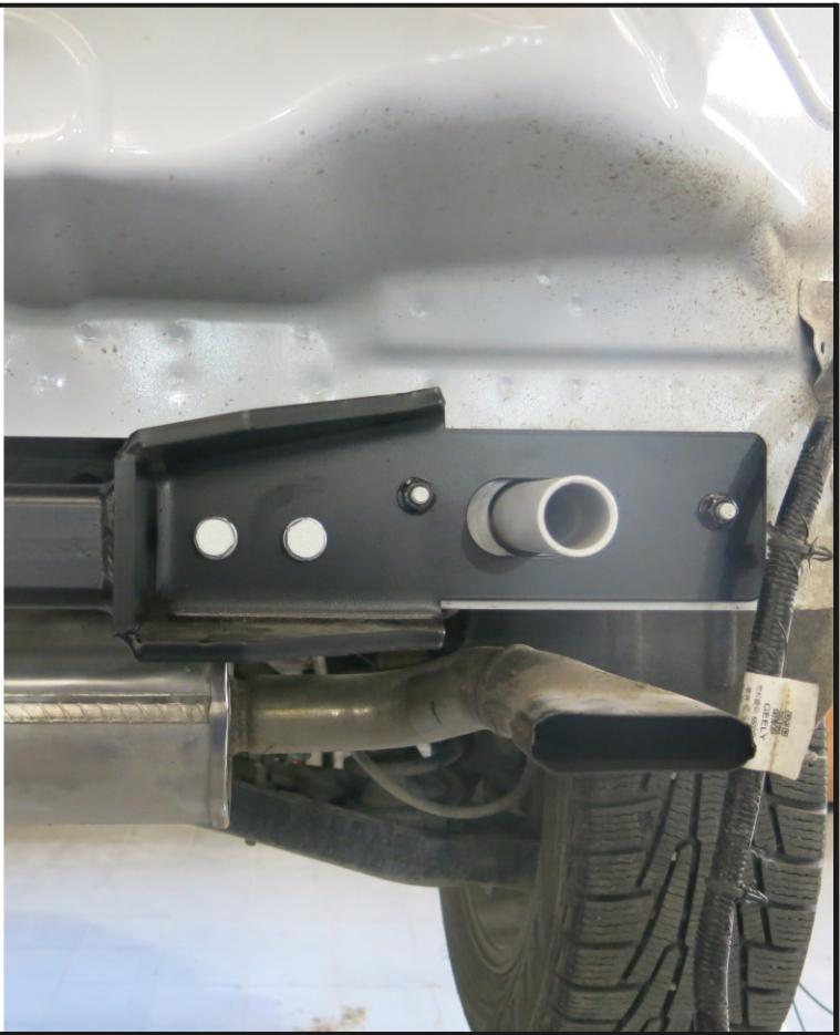
Затянуть все резьбовые соединения - сначала балки к задней панели, затем балки к кронштейнам и потом кронштейнов к лонжеронам. Моменты затяжки: M10=47 Нм, M8= 23 Нм.
