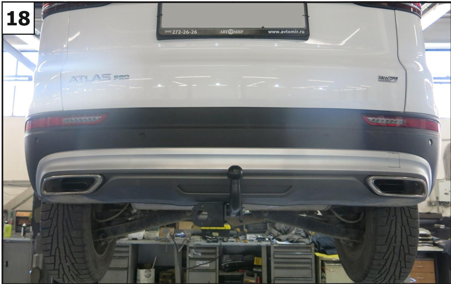
Установить кронштейн под розетку (6), крюк (7) и проставки (8) с помощью болтов M12x1,25x90 (16), шайб 12 (27), шайб 12 пружинных (28) и гаек M12x1,25 (18).
