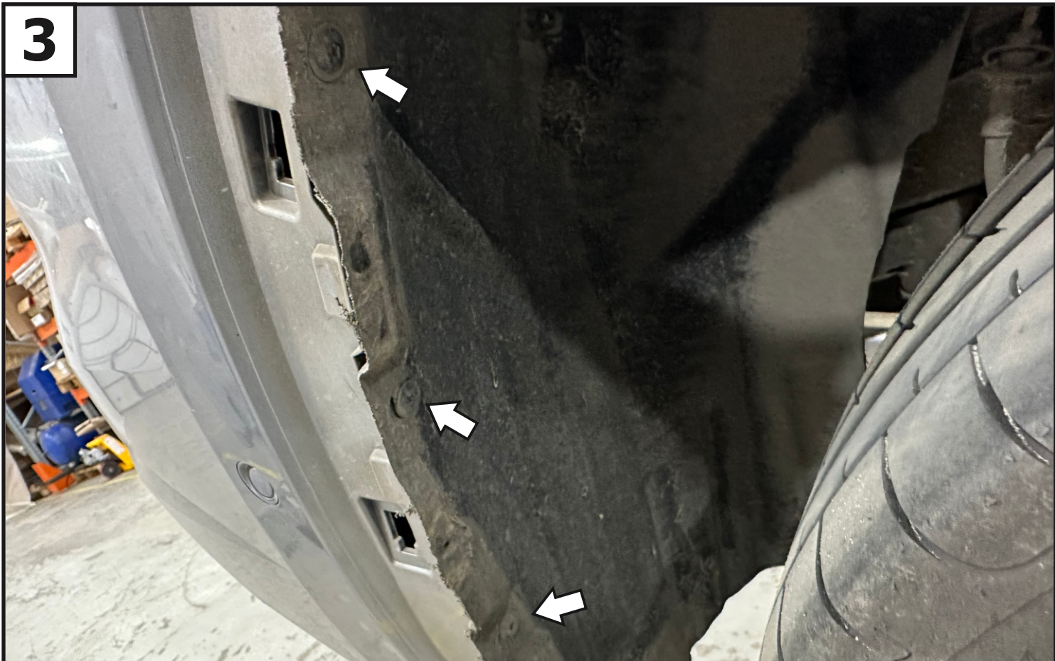
Открутить винты крепления подкрылка к бамперу с левой и правой стороны автомобиля.
