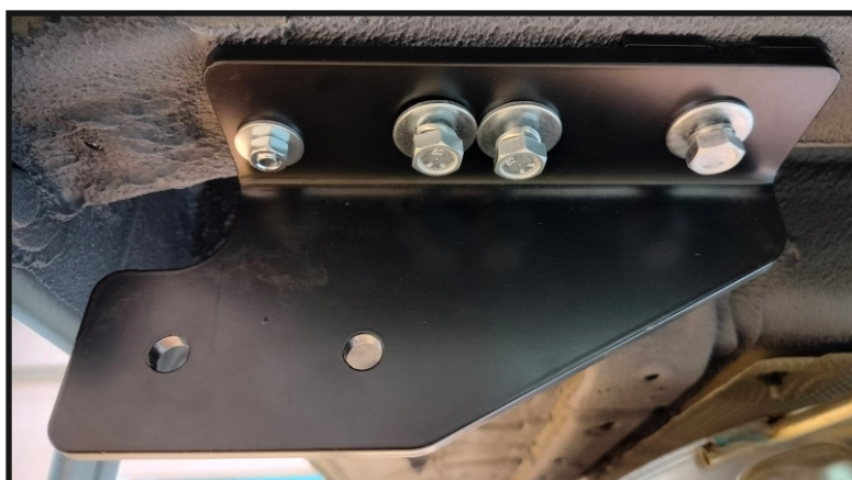
Установить левый и правый кронштейны (2 и 3), закрепив к закладным с помощью гаек М8 (11), шайб 8 пружинных (13), шайб 8 увел. (14), болтов М10х1,25х40 (8), шайб 10 пружинных (15) и шайб 10 увеличенных (16).
