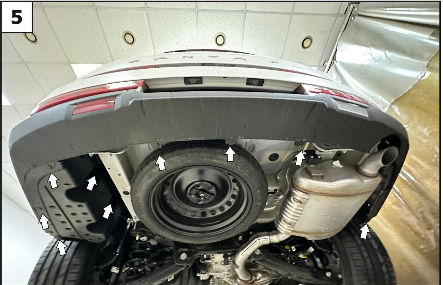
Демонтировать клипсы крепления бампера, открутить гайки крепления пыльника и демонтировать пыльник.
