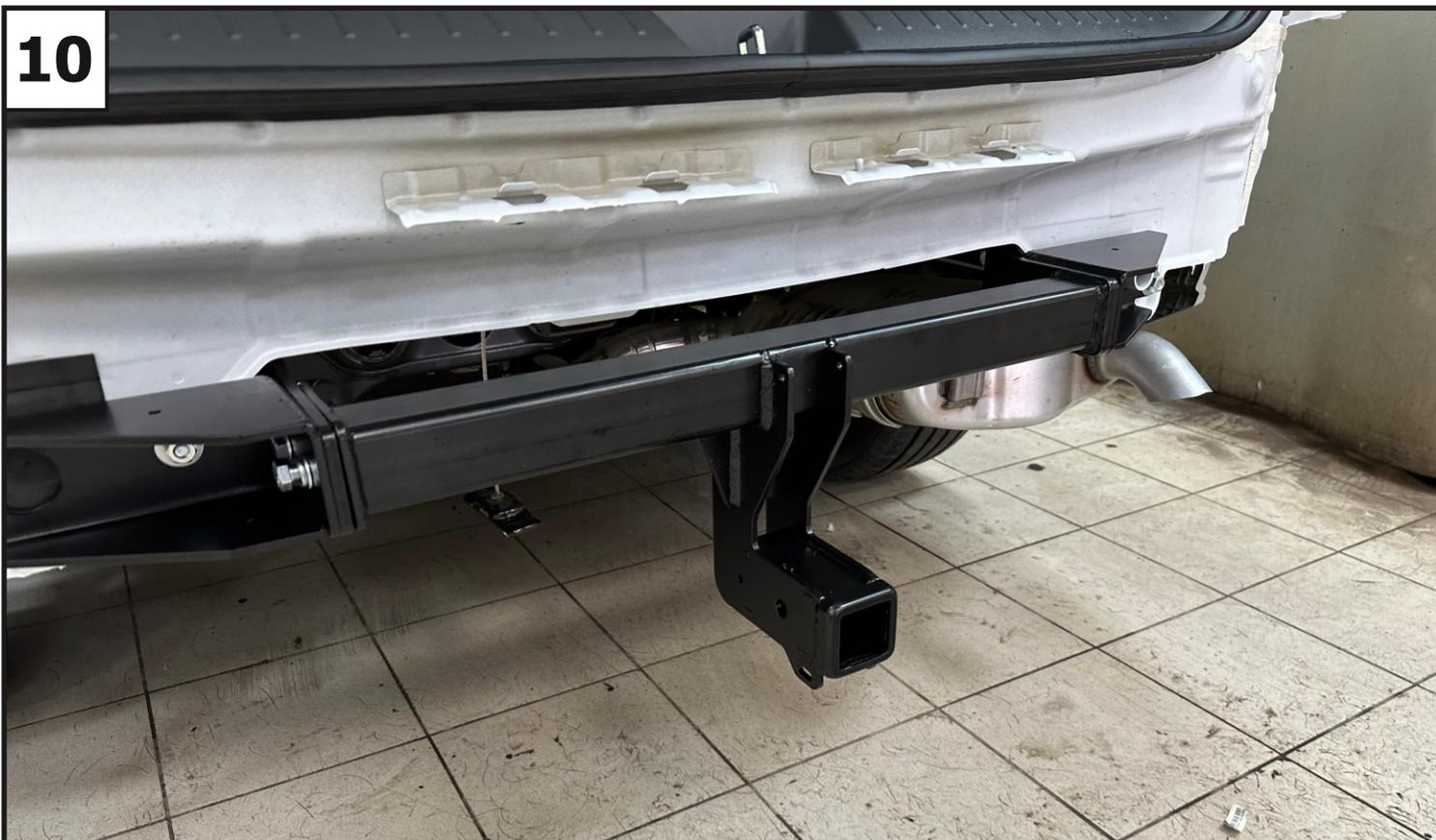
Прогнать резьбовые отверстия балки (1) с помощью метчика М12х1,25. Установить балку (1), закрепив её к кронштейнам с помощью болтов М12х1,25х50 (19), гаек М12х1,25 (23), шайб 12 пружинных (32) и шайб 12 (33). Затянуть все резьбовые соединения: сначала балку с кронштейнами, затем кронштейны с задней панелью, затем кронштейны с лонжеронами. Моменты затяжки: М10=47 Нм, М12=81 Нм.
