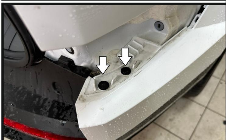
**Снять задние фонари и демонтировать расположенные под ними клипсы крепления бампера.**
