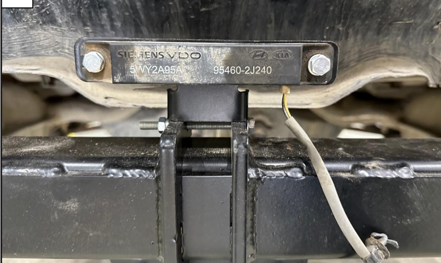
Закрепить кронштейн антенны (7) к балке и антенну к установленному кронштейну с помощью болтов М6х20 (14), гаек М6 (20), шайб 6 пружинных (24) и шайб 6 (25).
