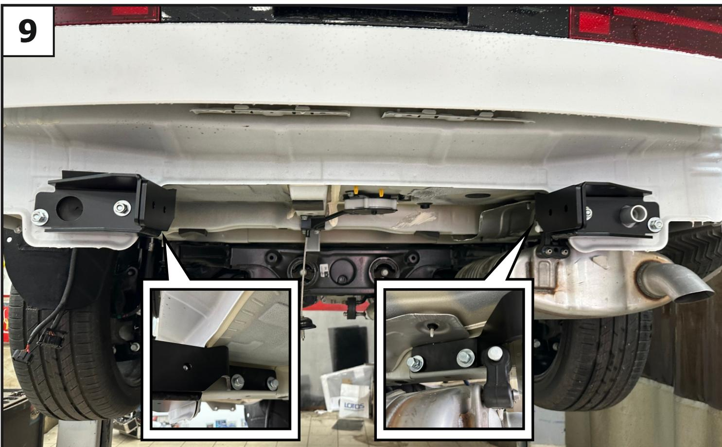
Закрепить левый и правый усиливающий кронштейны (2 и 3) к штатным резьбовым отверстиям в лонжеронах с помощью болтов М12х1,25х40 (18), шайб 12 пружин. (32) и шайб 12 увел. (34).
