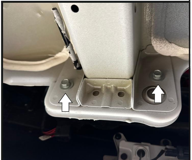
Выкрутить болты крепления усилителя с левой и правой стороны автомобиля. Демонтировать бампер вместе с усилителем.
