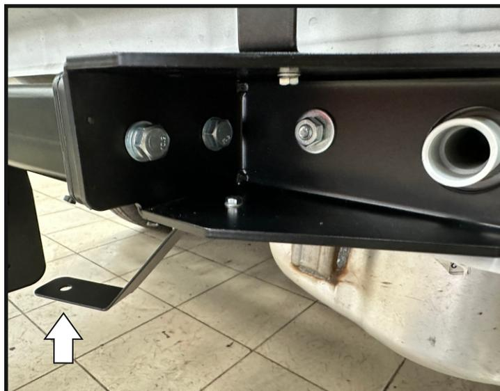
Установить бампер в обратном порядке, закрепив его к кронштейнам бампера (6) с помощью штатных клипс крепления бампера.
