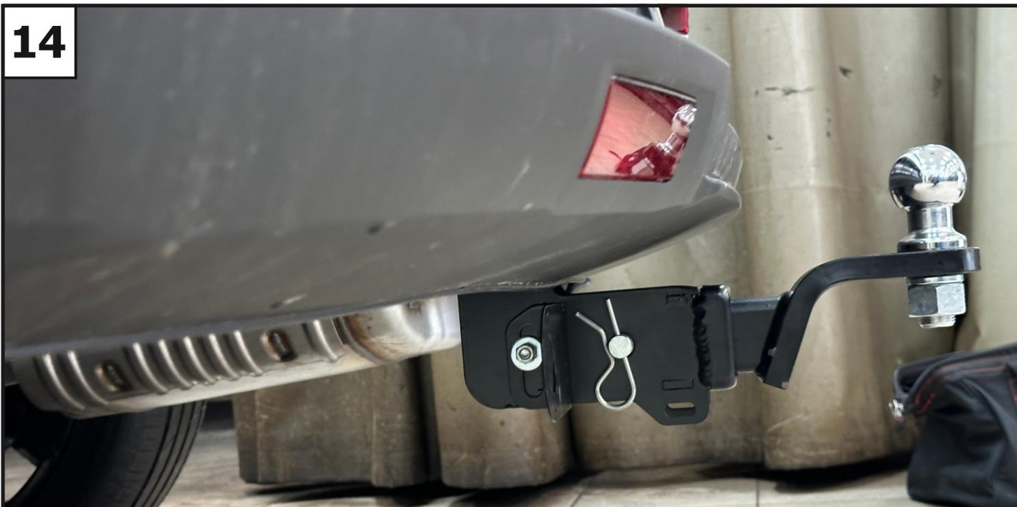
Закрепить кронштейн под розетку (9) с помощью болта М8х80 (15), гайки М8 (21), шайбы 8 пружинной (27), шайбы 8 (28) и шайбы 8 увел. (29). Затянуть резьбовое соединение. Момент затяжки: М8=25 Нм. Установить переходник (10), закрепив с помощью штифта (12) и шплинта (13). Зафиксировать переходник болтом М10х20 (16) - фиксацию использовать без нагрузки. Установить на переходник шар (11), закрепив гайкой М24 (36) и шайбой 24 пружинной (35). Затянуть резьбовое соединение. Момент затяжки: М24=95 Нм.
