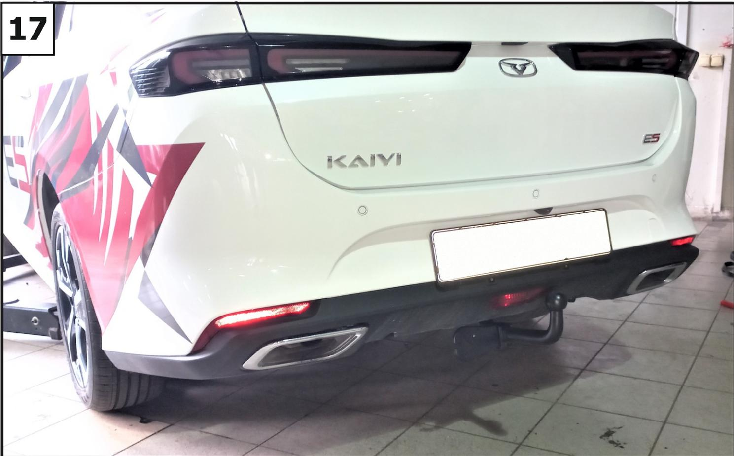
**Затянуть все резьбовые соединения. Моменты затяжки М12=81 Нм.**
