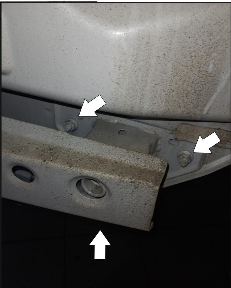
Демонтировать проводку от заднего усилителя и открутить гайки крепления усилителя. Демонтировать усилитель.
