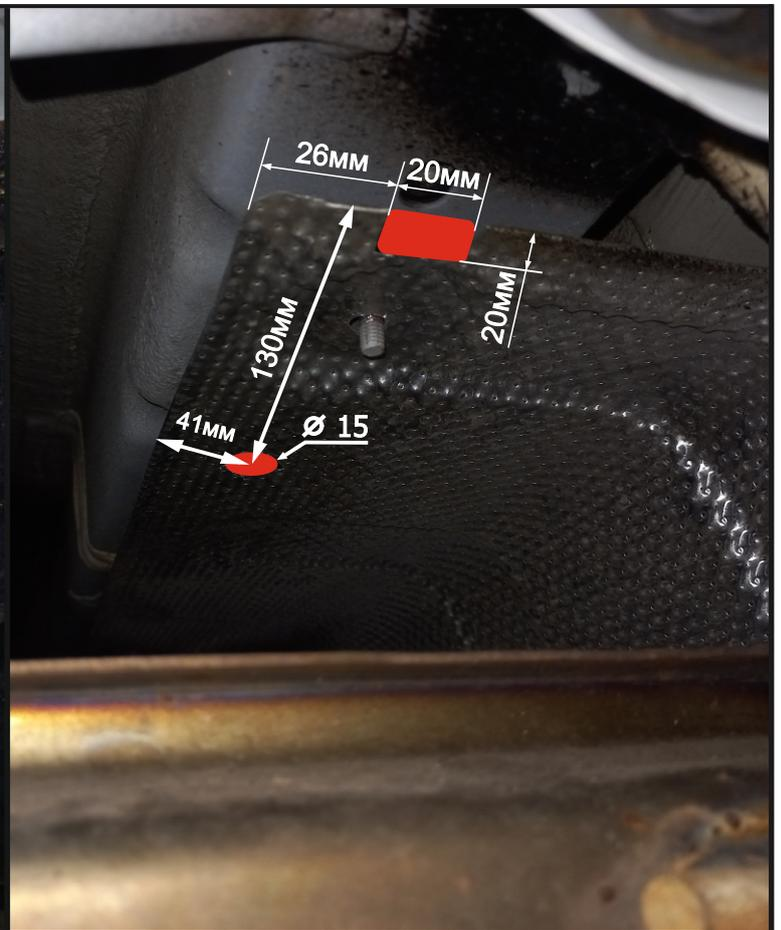
Демонтировать защитный экран за глушителем. После прорезать в нем отверстия для крепления кронштейна под болт М12.
