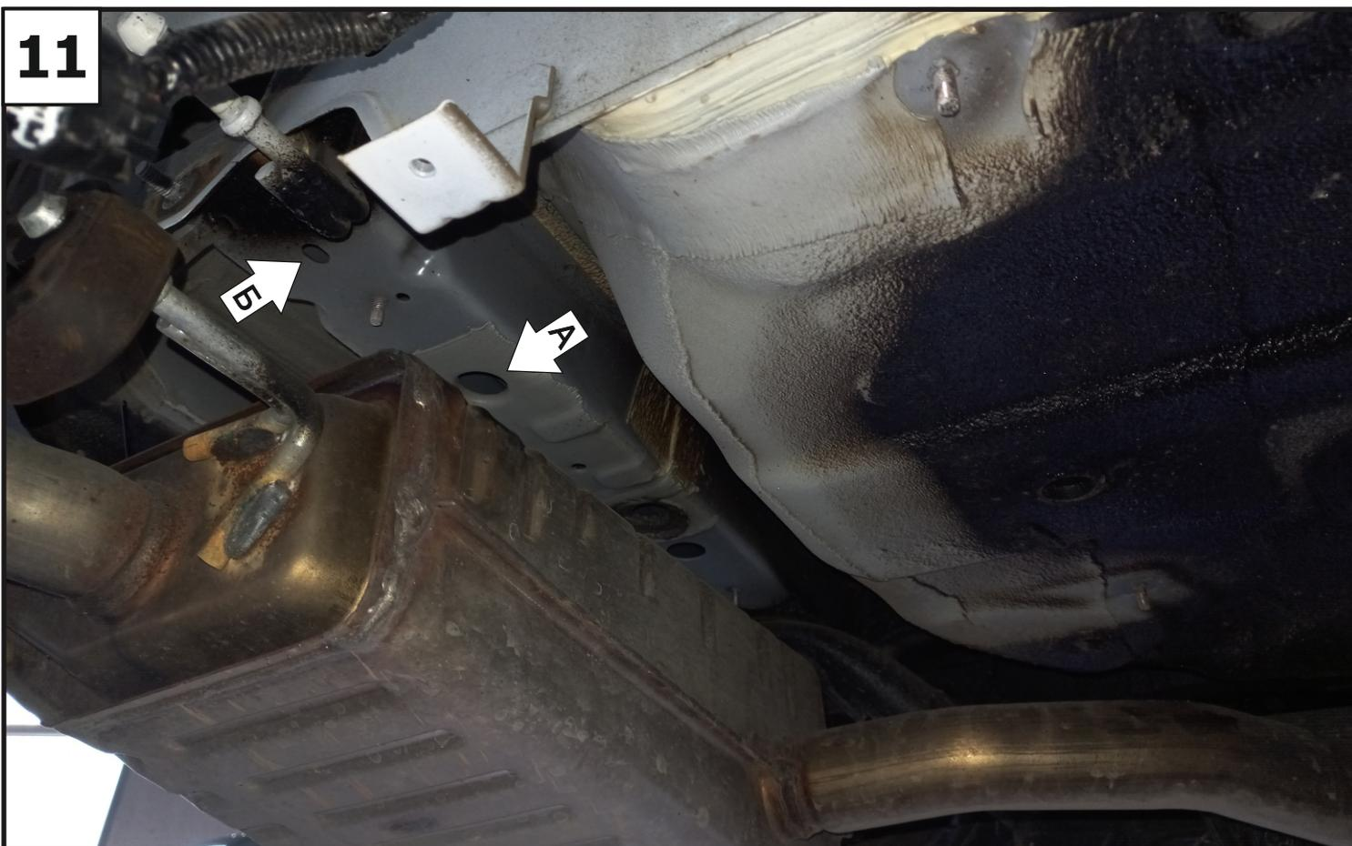
Установить закладную 1 в отверстие А и закладную 2 в отверстие Б в лонжероны автомобиля с правой и левой стороны.
