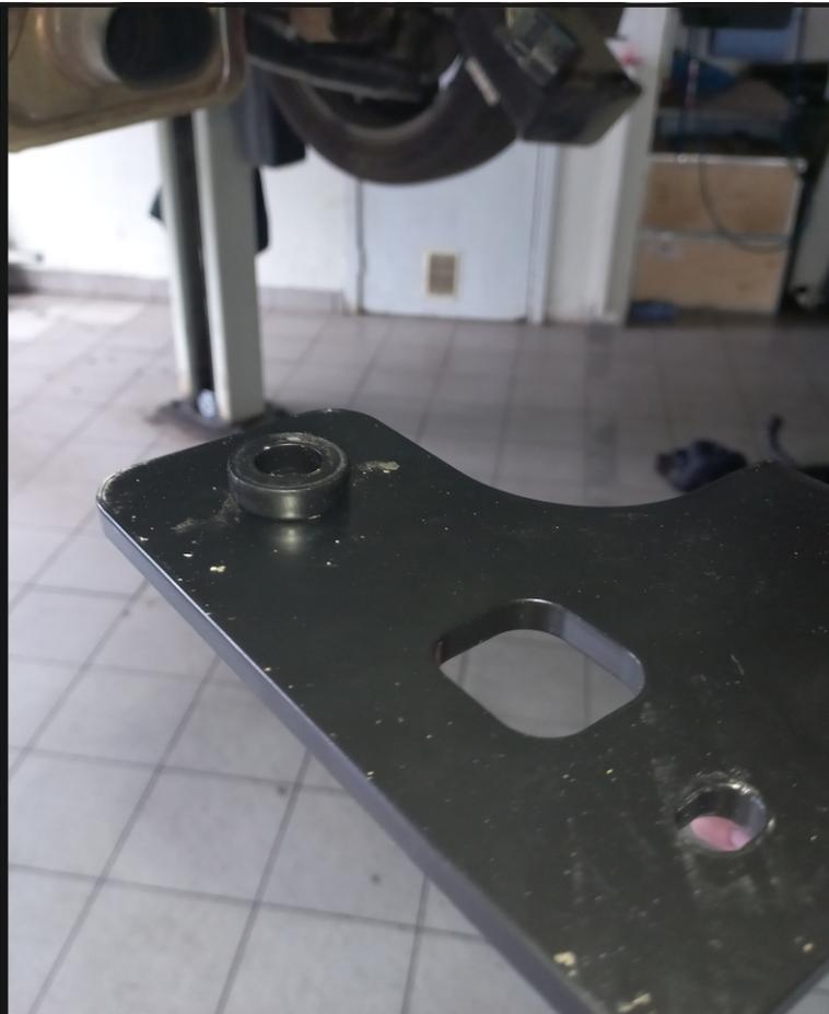
Установить кронштейн правый (3) вместе с проставкой (8) закрепив к закладным с помощью болтов М10х1,25х35 (9), болтов М10х1,25х50 (10), шайб 10 (14) и шайб 10 пружинных (15).
