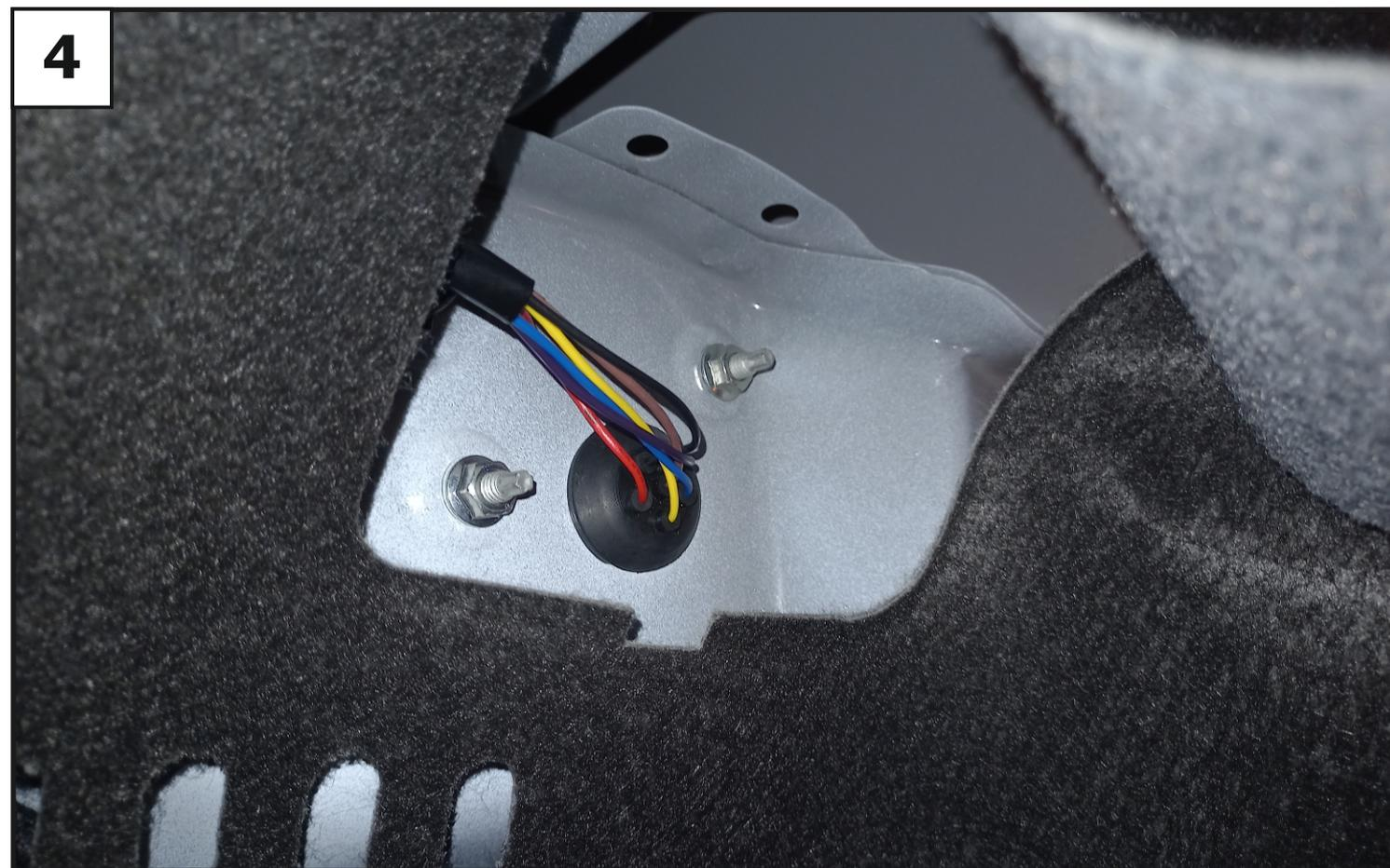
**В багажнике выкрутить гайки крепления задних фонарей с левой и правой части автомобиля.**
