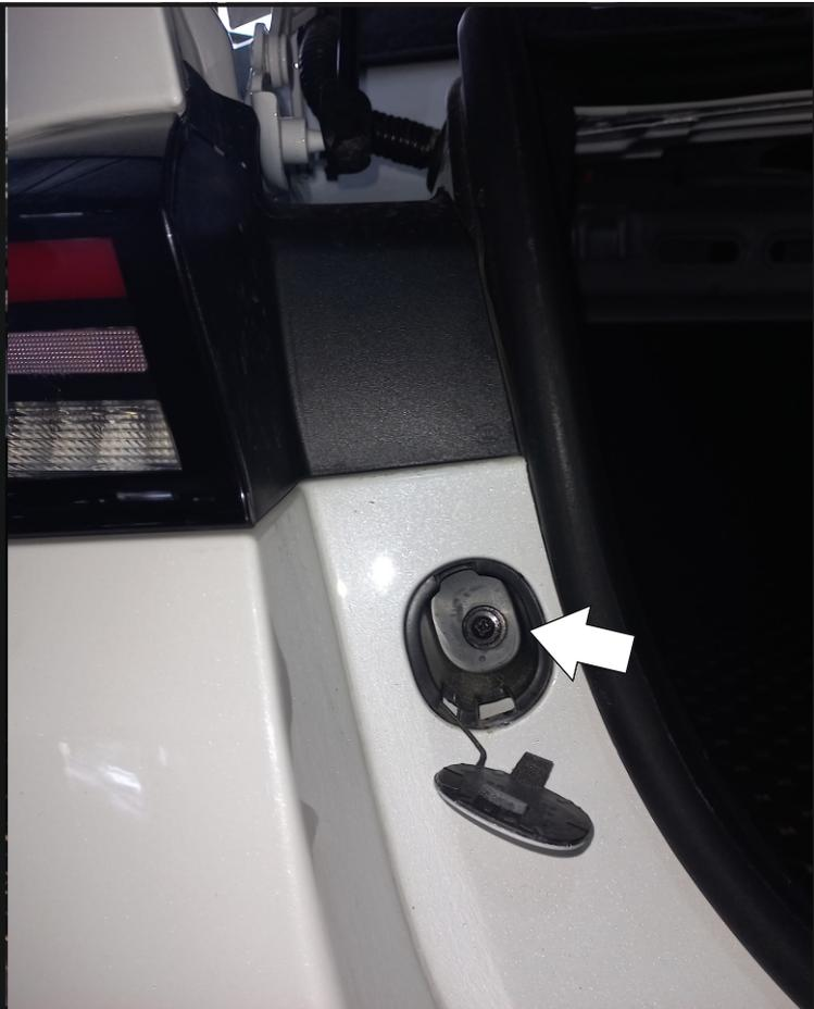
Открыть заглушки задних фонарей и выкрутить винты крепления бампера с левой и правой части автомобиля. Демонтировать бампер.
