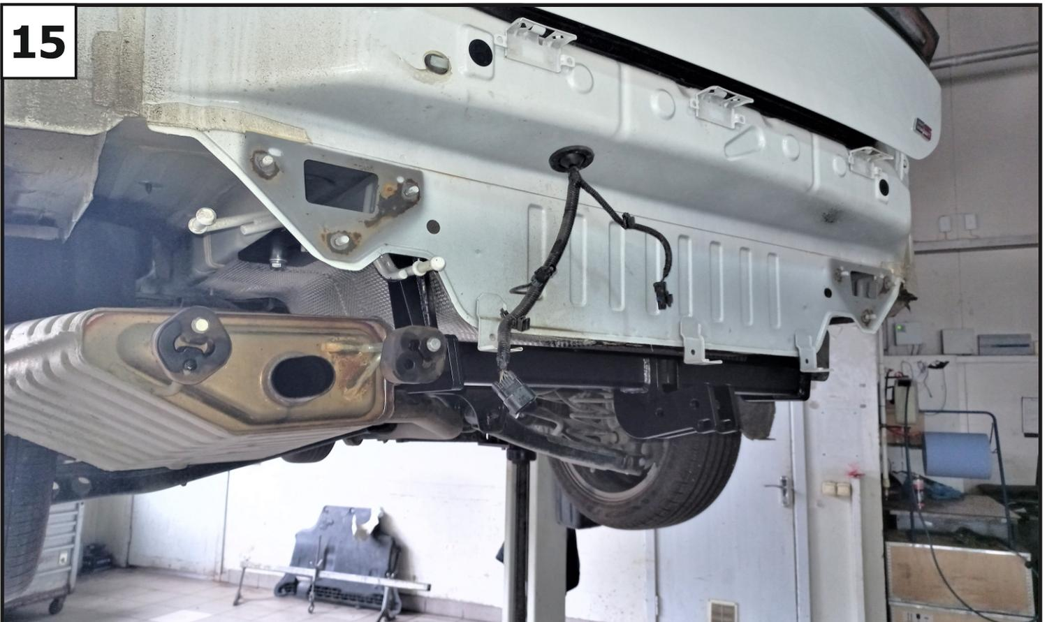
Затянуть все резьбовые соединения. Моменты затяжки: М10=47 Нм, М12= 81 Нм. Установить абсорбер на штатное крепление и глушитель на подвесы. После установить усилитель и задний бампер в обратной последовательности
