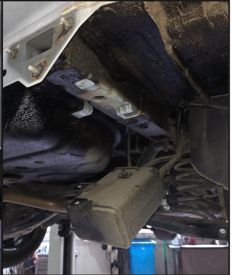
Снять абсорбер со штатных креплений и глушитель с подвесов.
