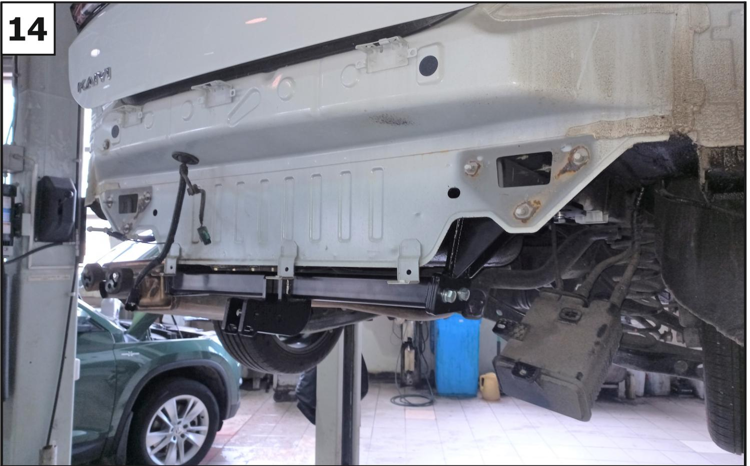
К установленным кронштейнам закрепить балку (1) с помощью болтов М12х1,25х40 (11), гаек М12х1,25 (13), шайб 12 (16) и шайб 12 пружинных (17).
