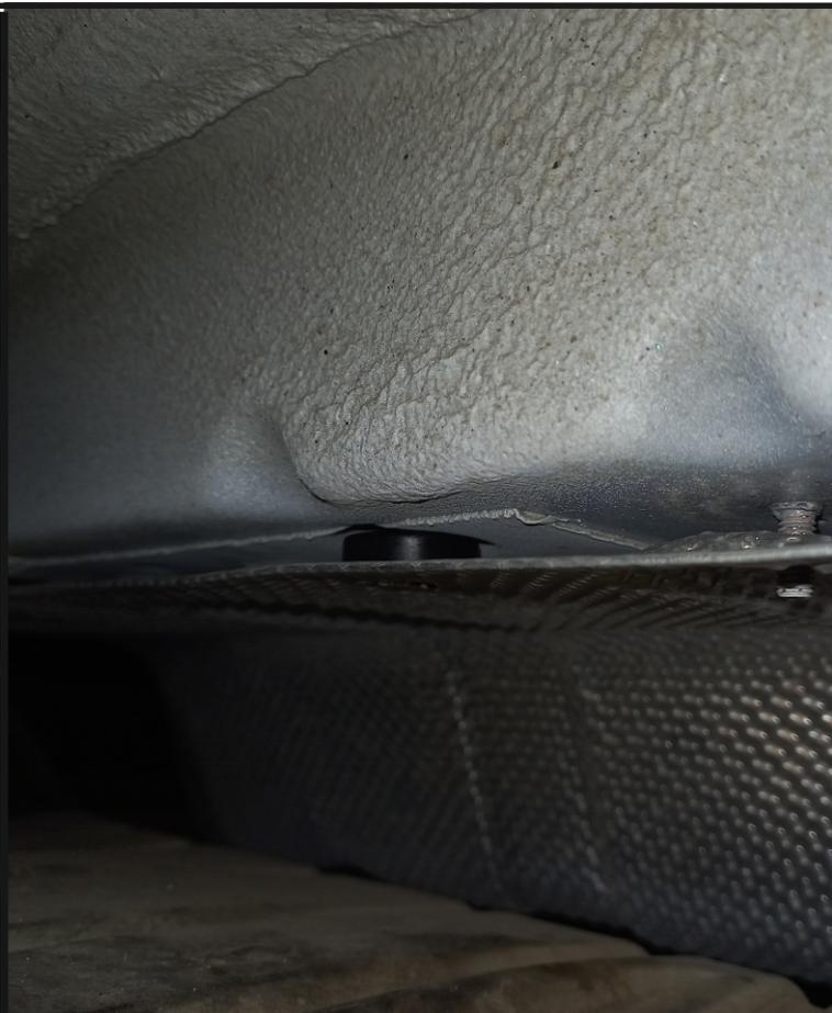
С левой стороны установить защитный экран вместе с проставкой (8). Установить кронштейн левый (2) закрепив к закладным с помощью болтов М10х1,25х35 (9), болтов М10х1,25х50, шайб 10 (14) и шайб 10 пружинных (15).
