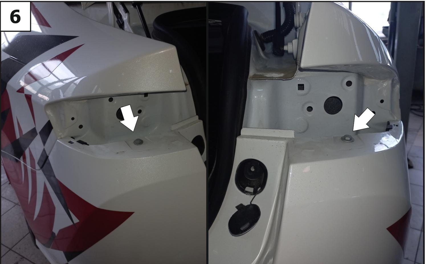
**Демонтировать задние фонари и выкрутить винты крепления бампера с левой и правой части автомобиля.**
