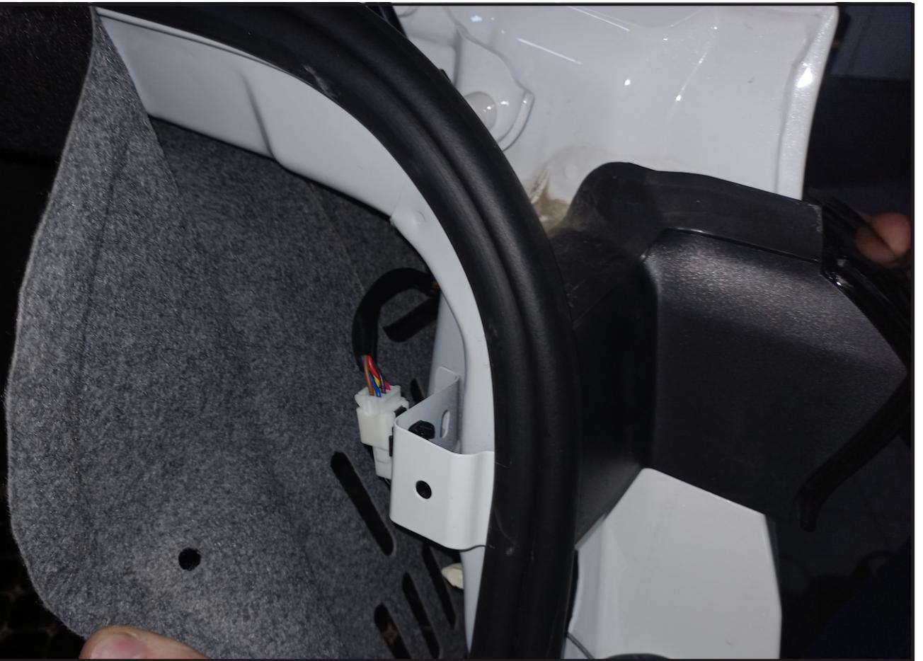
**Снять обшивку багажника и отсоединить разъемы на задних фонарях с правой и левой стороны.**
