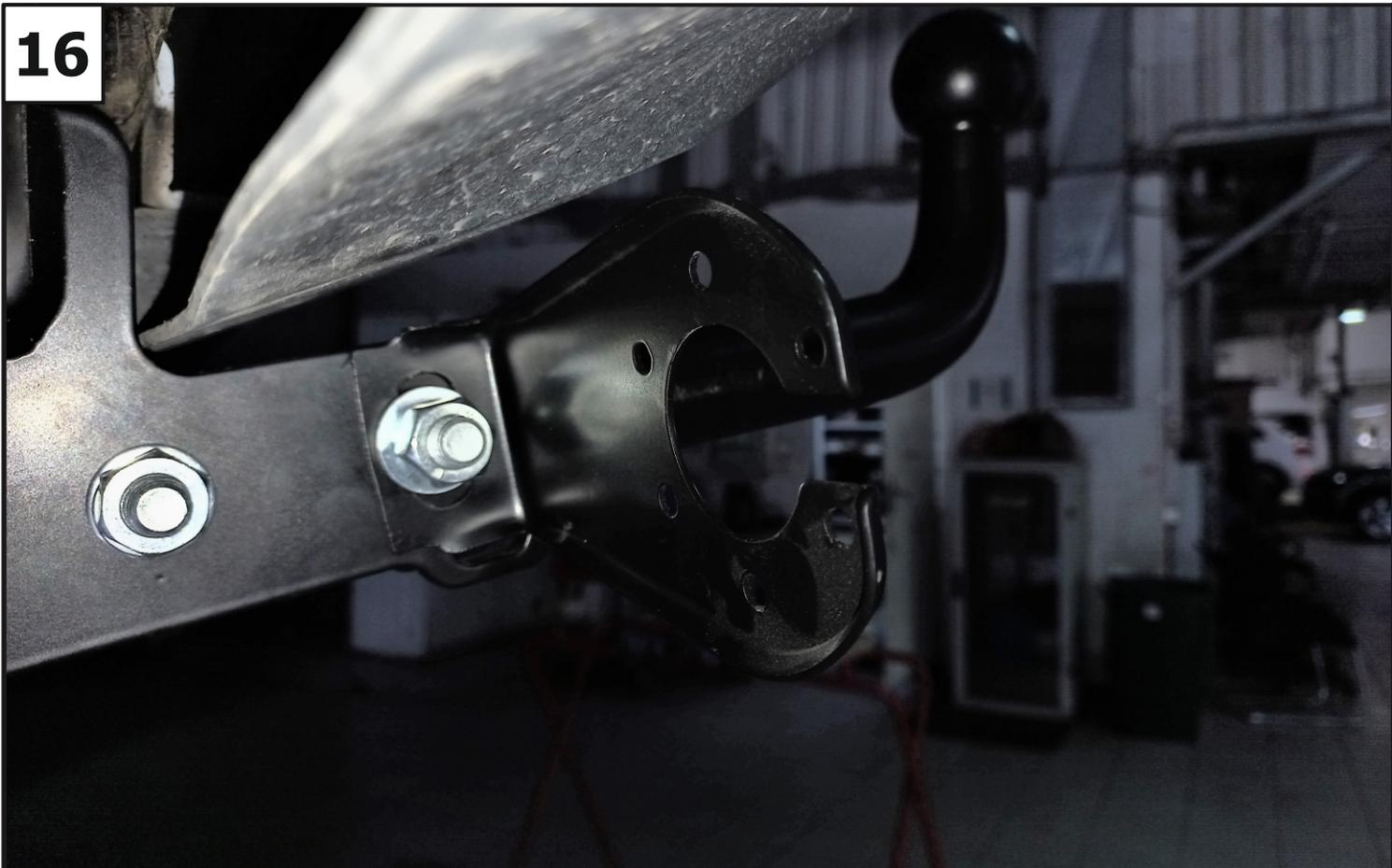
**Установить кронштейн под розетку (6) и крюк (7) с помощью болтов М12х1,25х70 (12), шайб 12 (16), шайб 12 пружинных (17) и гаек М12х1,25 (13).**
