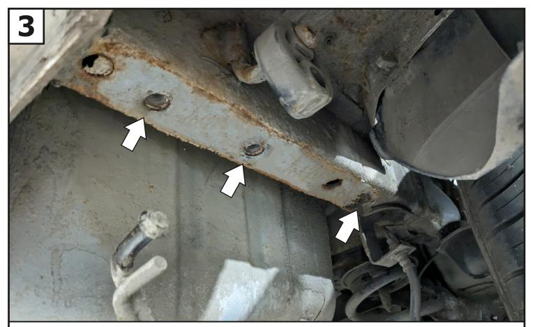
Установить правый кронштейн (2), закрепив его к лонжерону автомобиля в штатные отверстия с резьбой M12x1,25 при помощи болтов M12x1,25x40 (7), шайб 12 пружинных (12) и шайб 12 увел. (13).
