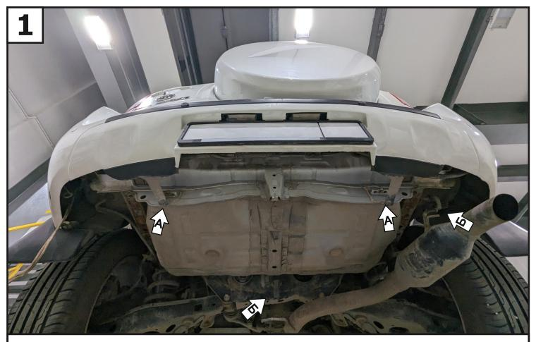
Снять клипсы крепления бампера А. Также для удобства установки рекомендуется снять глушитель с подвесов Б.
