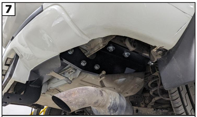
Перед установкой балки ТСУ (1) необходимо прогнать ее резьбовые отверстия при помощи метчика M12x1,25. Затем к установленным кронштейнам (2 и 3) закрепить балку (1) при помощи болтов M12x1,25x40 (7), шайб 12 пружинных (12), шайб 12 (11) и гаек M12x1,25 (10).
