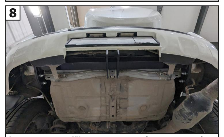
Отрегулировать положение ТСУ относительно центра автомобиля и затянуть все резьбовые соединения— сначала балку с кронштейнами, затем кронштейны с лонжеронами автомобиля. Моменты затяжки: M12=81 Нм. После закрепить нижние крепления бампера на клипсы и установить глушитель на подвесы.
