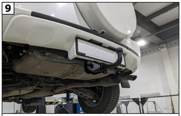
Установить кронштейн под розетку (5) и крюк (6) при помощи проставок (4), болтов M12x1,25x90 (9), шайб 12 пружинных (12), шайб 12 (11) и гаек M12x1,25 (10).
