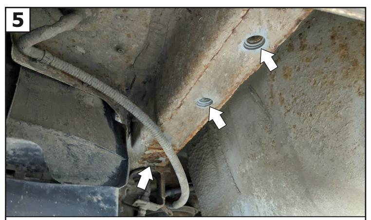
Установить левый кронштейн (3) совместно со штатной буксировочной петлей (при ее наличии), закрепив их к лонжерону автомобиля в штатные отверстия с резьбой М12х1,25 при помощи болтов М12х1,25х45 (8), болта М12х1,25х40 (7), шайб 12 пружинных (12) и шайб 12 увел. (13).
