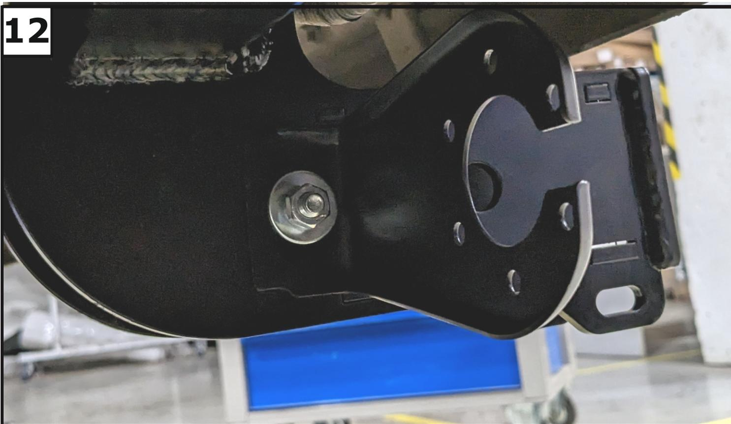
**Установить кронштейн под розетку (4), закрепив его с помощью болта M8x80 (9), шайбы 8 (15), шайбы 8 увел. (16), шайбы 8 пруж. (14) и гайки M8 (12). Затянуть резьбовое соединение. Момент затяжки: M8=25 Нм.**
