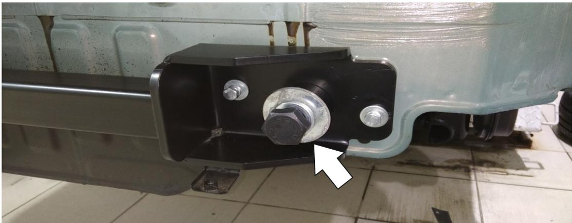
Закрепить установленную балку (1) с помощью болтов М22х1,5х60 (11), шайб 22 пружинных (17), шайб 22 увел. (18).
