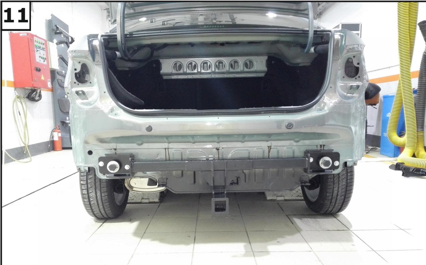
**Затянуть все резьбовые соединения. Моменты затяжки: M8=25 Нм, M22=95 Нм.
