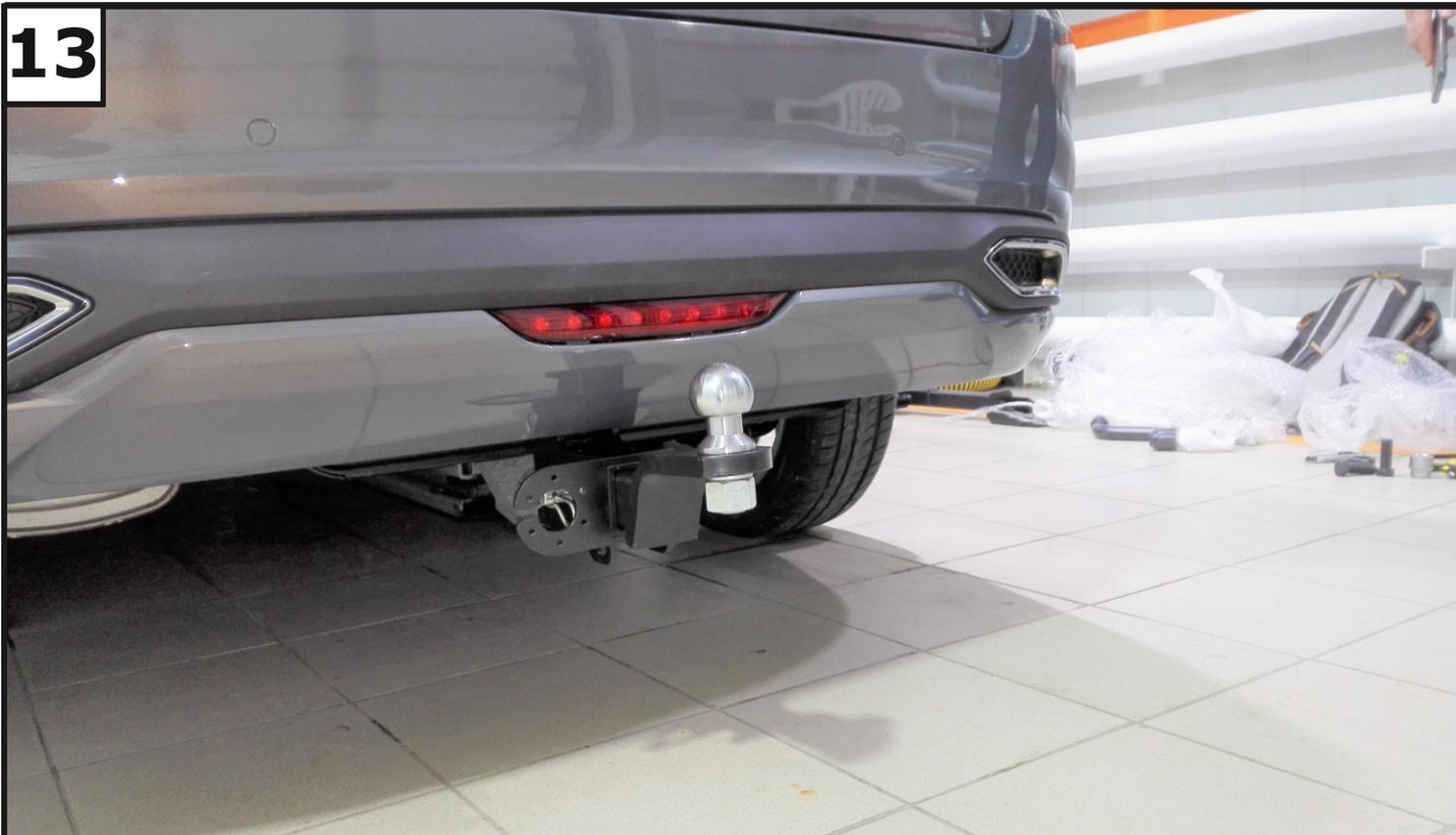
**Установить переходник (2), закрепив с помощью штифта (5) и шплинта (6). Зафиксировать переходник болтом М10х20 (10) - фиксацию использовать только без нагрузки. Установить на переходник шар (3), закрепив гайкой М24 (13) с шайбой 24 пружинной (19). Момент затяжки М24=95 Нм.**
