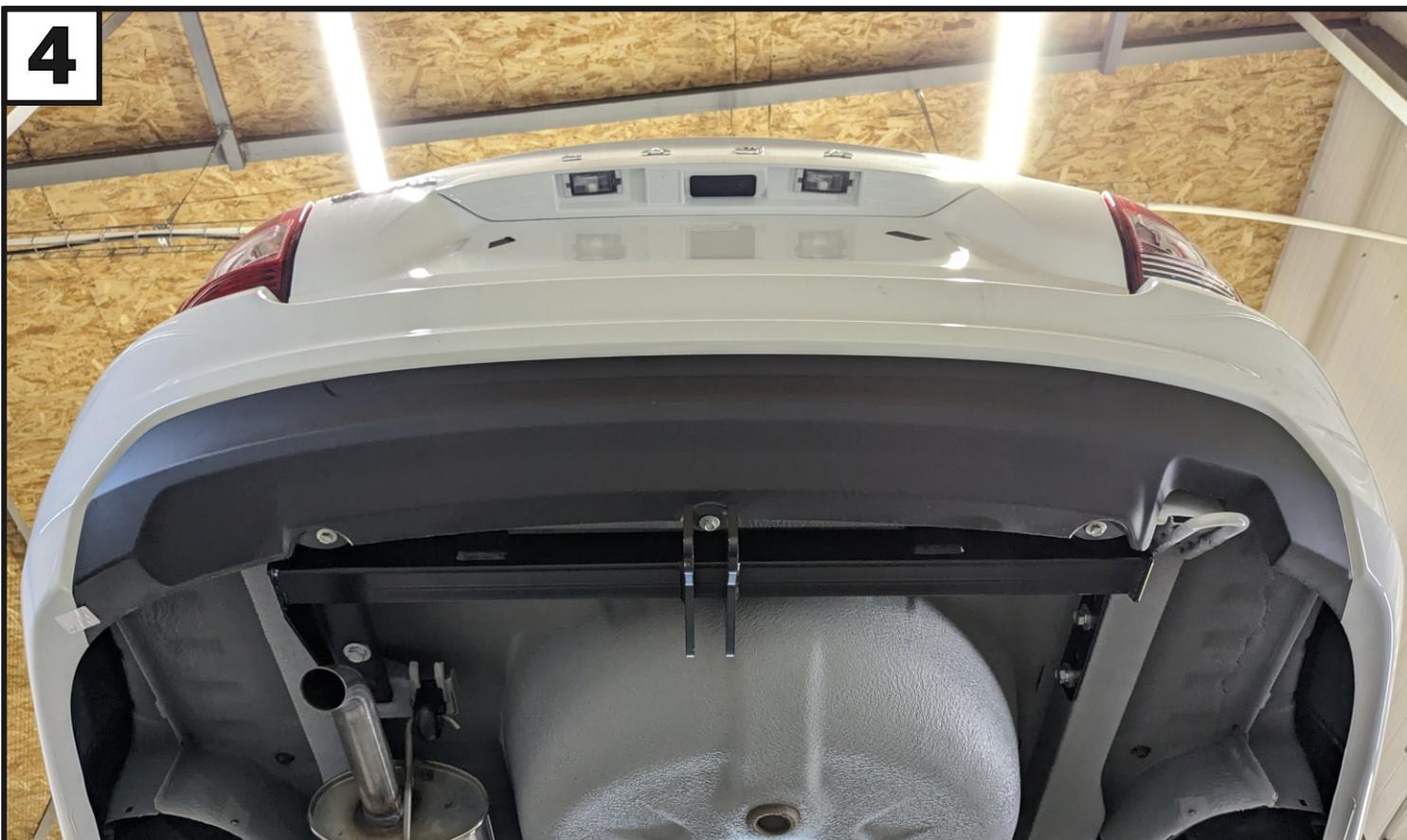
**Закрепить балку (1) с помощью болтов М10х1,25х35 (5), шайб 10 пружинных (9) и шайб 10 увеличенных (10) к правому лонжерону: для Lada Granta SW/ Kalina SW - отверстия В, С; для Lada Granta SE/LB - отверстия Е, F.**
