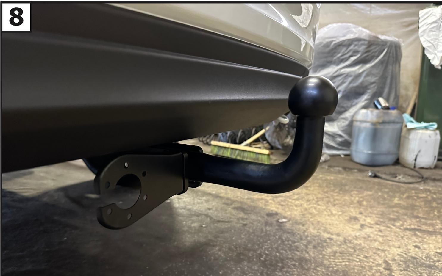
**Установить кронштейн под розетку (3) и крюк (4) с помощью болтов M12x1,25x70 (6), шайб 12 (12), шайб 12 пружинных (11) и гаек M12x1,25 (8).**
