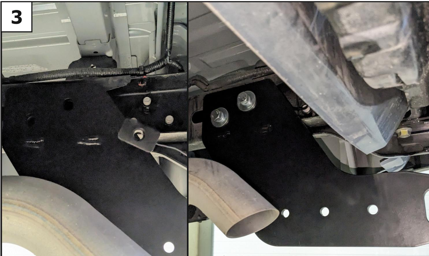
Установить в лонжерон закладные (6) и закрепить к ним кронштейн с помощью болтов М12х1,25х40 (14), шайб М12 пружинных (20) и шайб 12 увеличенных (22). Кронштейн левый (2) установить аналогично.
