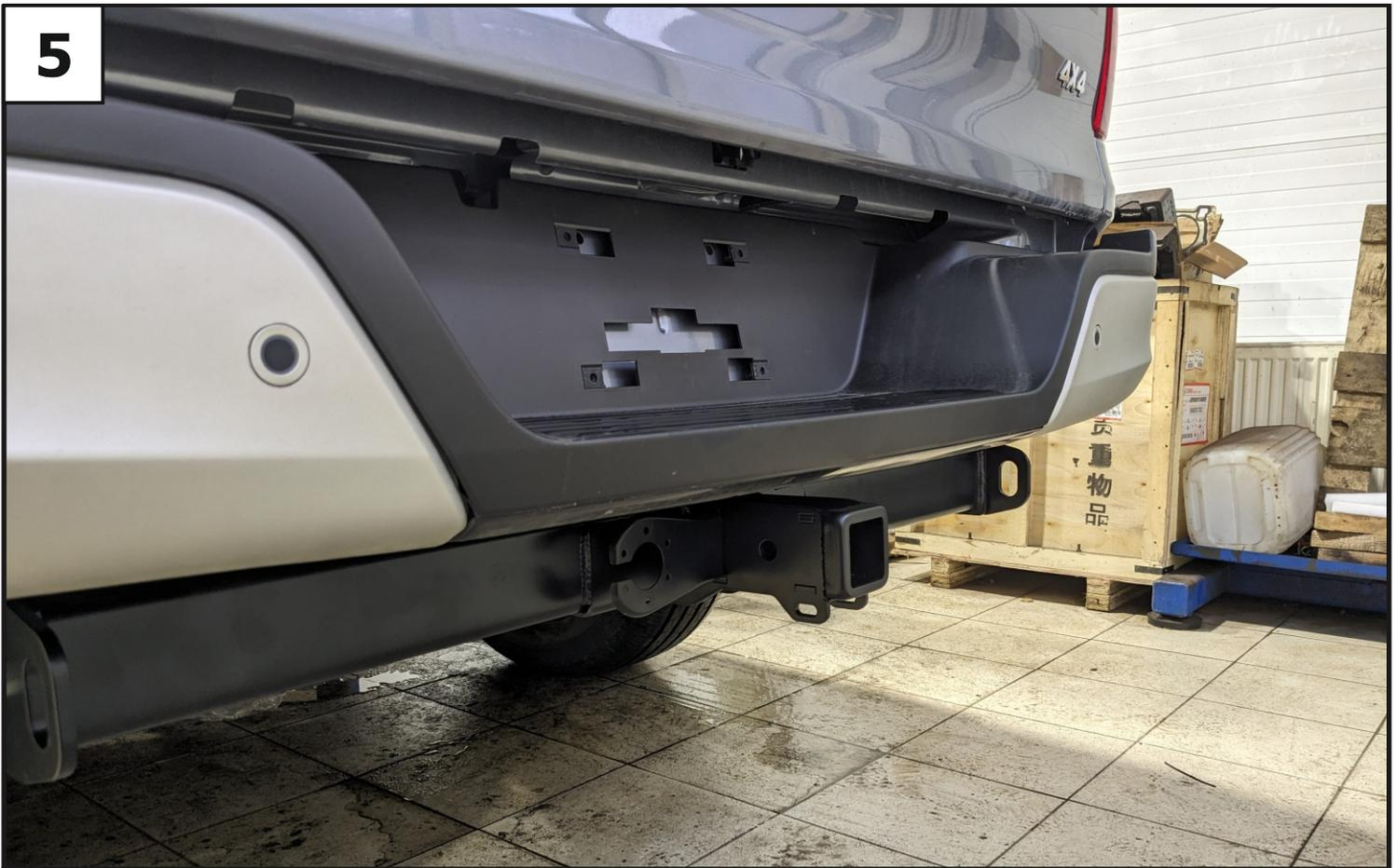
**Затянуть все резьбовые соединения: сначала балку с кронштейнами, затем кронштейны к раме. Моменты затяжки: M12=81 Нм.**
