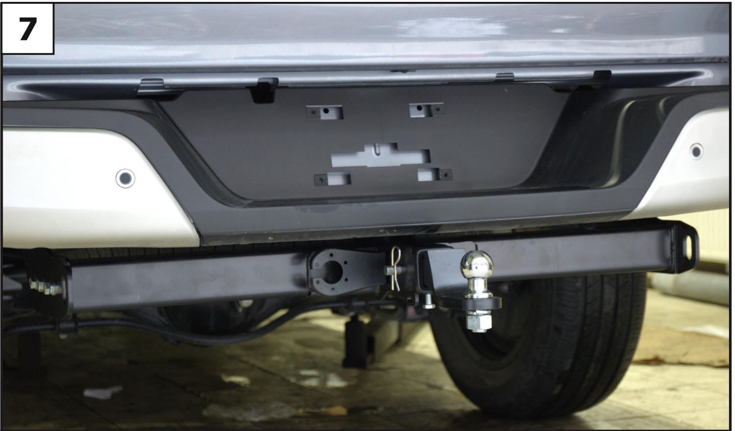
**Установить переходник (7), закрепив с помощью штифта (9) и шплинта (10). Зафиксировать переходник болтом M10x20 (13) - фиксацию использовать без нагрузки. Установить на переходник шар (8), закрепив гайкой M24 (24) с шайбой 24 пружинной (23). Момент затяжки: M24=95 Нм.**
