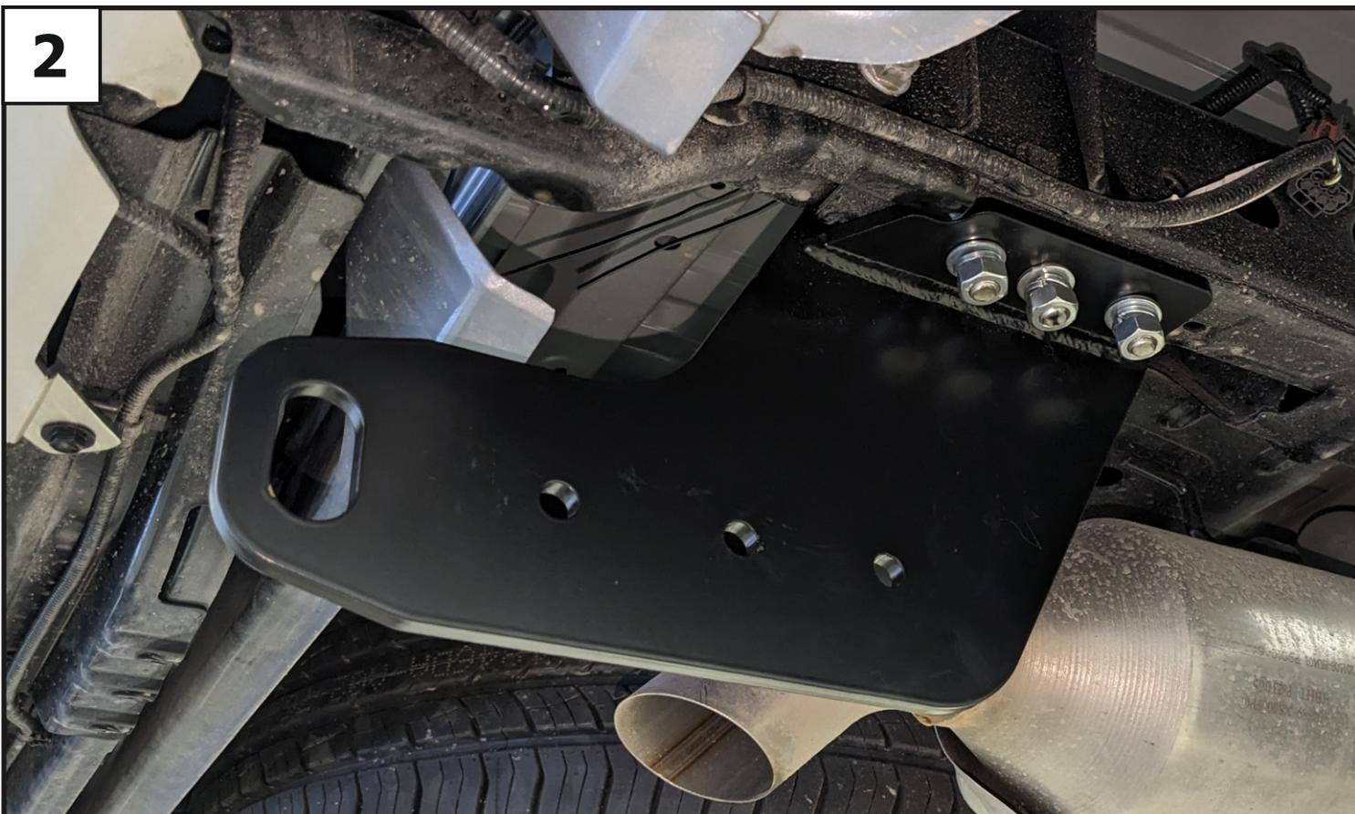
Установить кронштейн правый (3), закрепив его к установленной закладной с помощью гаек М12х1,25 (16), шайб М12 пружинных (20) и шайб 12 (21). Кронштейн левый (2) установить аналогично.
