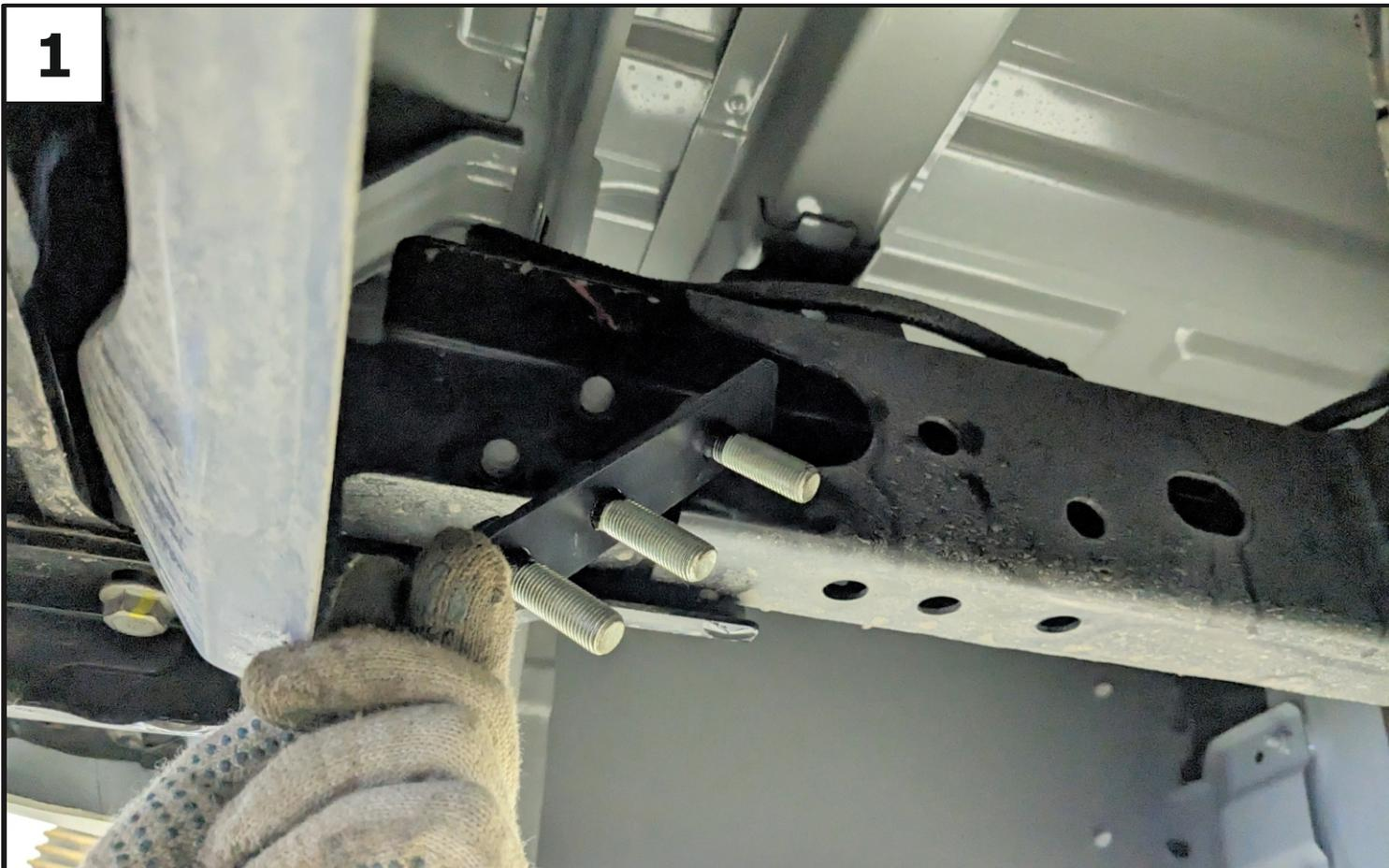
Установить закладную М12х1,25 левую (4) и правую (5) в лонжероны рамы.
