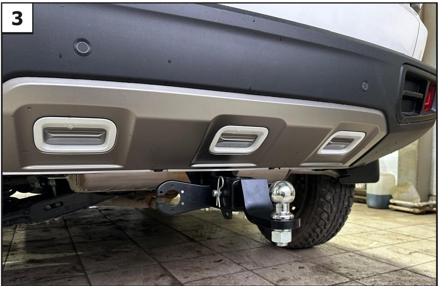
**Установить кронштейн под розетку (8) с помощью болта M8x80 (9), шайбы 8 пружинной (15), шайбы 8 (16), шайбы 8 увел. (17) и гайки M8 (12). Установить переходник (4), закрепив его с помощью штифта (6) и шплинта (7). Зафиксировать переходник болтом M10x20 (10) - фиксацию использовать без нагрузки. Установить на переходник шар (5), закрепив его гайкой M24 (21) и шайбой 24 пружинной (22). Затянуть резьбовые соединения. Момент затяжки: M8=25 Нм; M24=95 Нм.**
