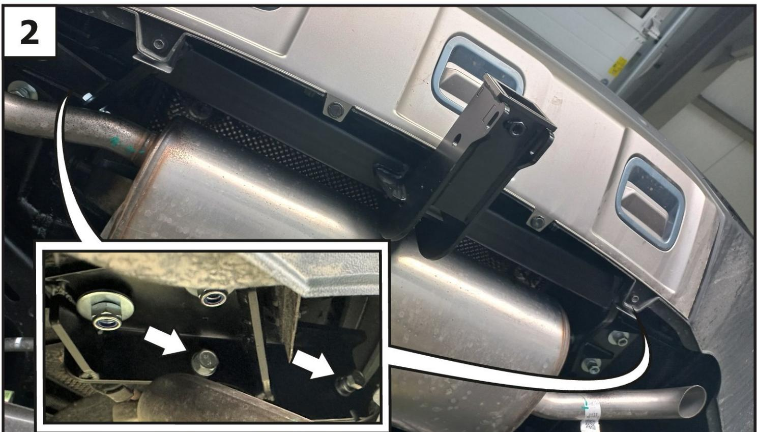
Прогнать резьбовые отверстия балки (1) с помощью метчика M12x1,25. Закрепить балку (1) к установленным кронштейнам с помощью болтов M12x1,25x40 (11), шайб 12 пружинных (18), шайб 12 (19) и гаек M12x1,25 (13). Затянуть все резьбовые соединения - сначала балку с кронштейнами, после - кронштейны к лонжеронам. Момент затяжки: M12= 81 Нм.
