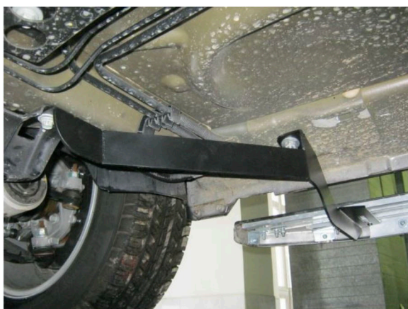
Рис.4 Установка переднего кронштейна.
