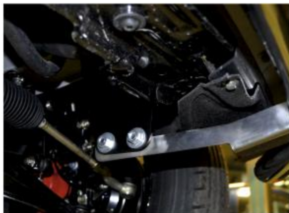
Рис. 4 - Установка защиты переднего бампера
