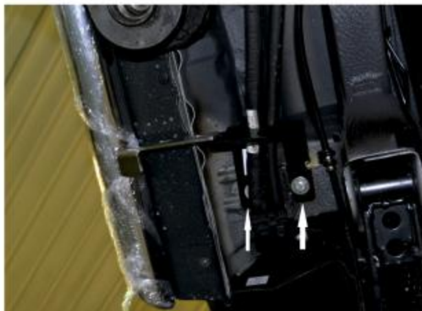
Рис. 1 - Установка переднего кронштейна
