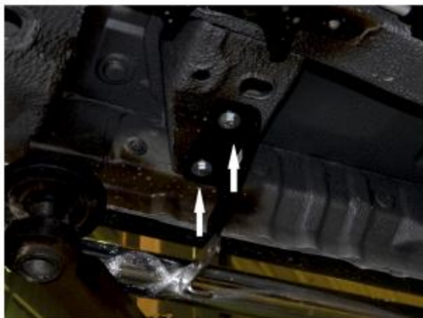
Рис. 2 - Установка заднего кронштейна
