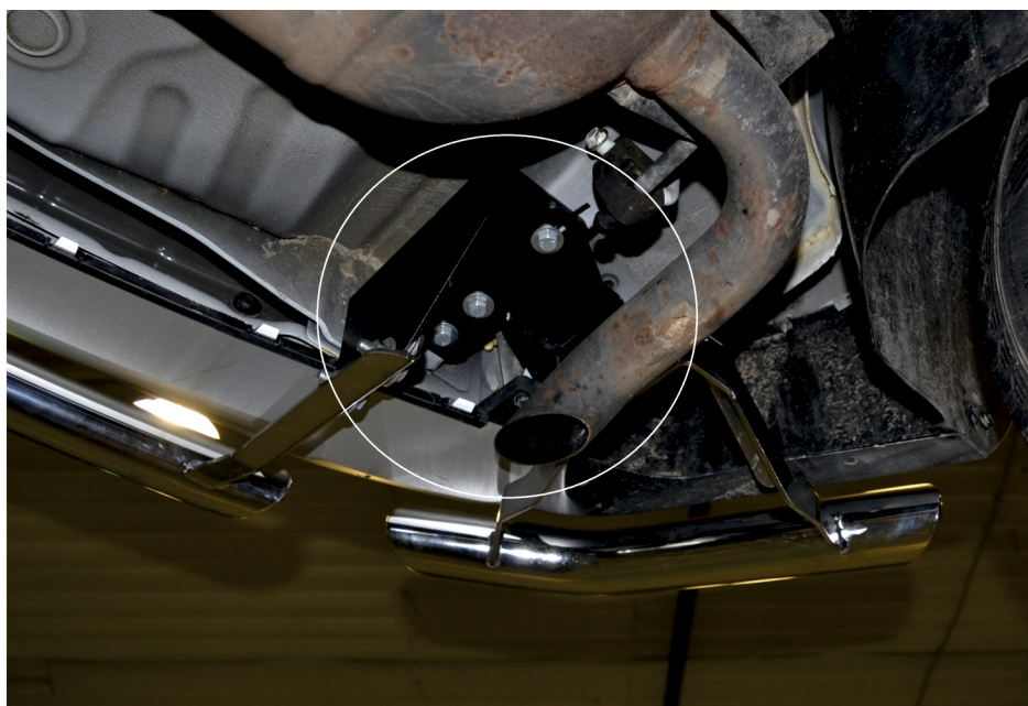
Рис. 5 - Совместная установка защиты R.3305.007 и уголков R.3305.005
