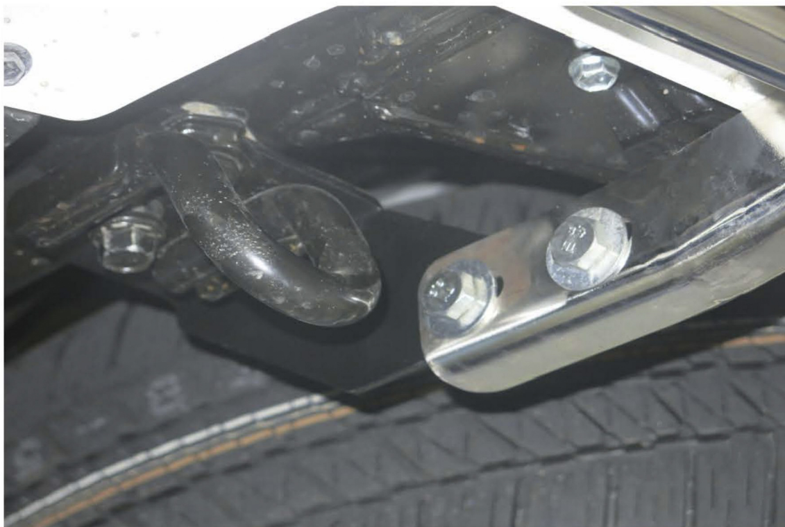
Рис. 1 Установка левого кронштейна
