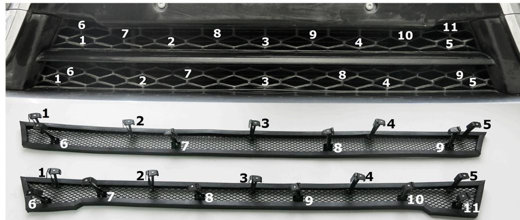
5. Установить защитную решетку поверх штатной решетки радиатора автомобиля, попав кронштейнами в соответствующие им ячейки. Убедитесь в том, что крючки, расположенные на кронштейнах, смогут зацепиться за штатную решетку радиатора автомобиля изнутри.
